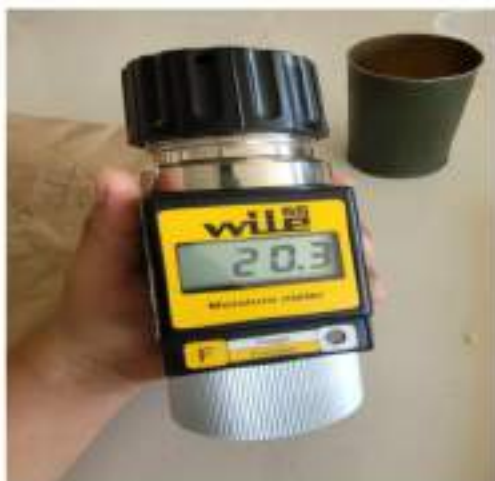
Figura 5. Medición de humedad (%).
