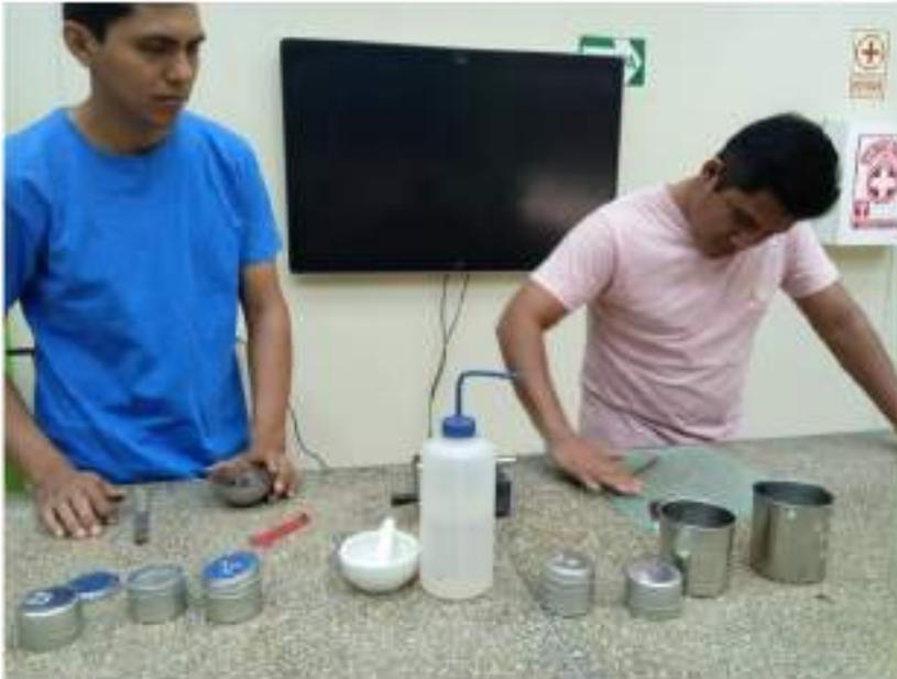
**Fotografía N° 07:** Se observa a los bachilleres realizando el ensayo de límite plástico, hasta obtener la forma cónica de 3 mm
