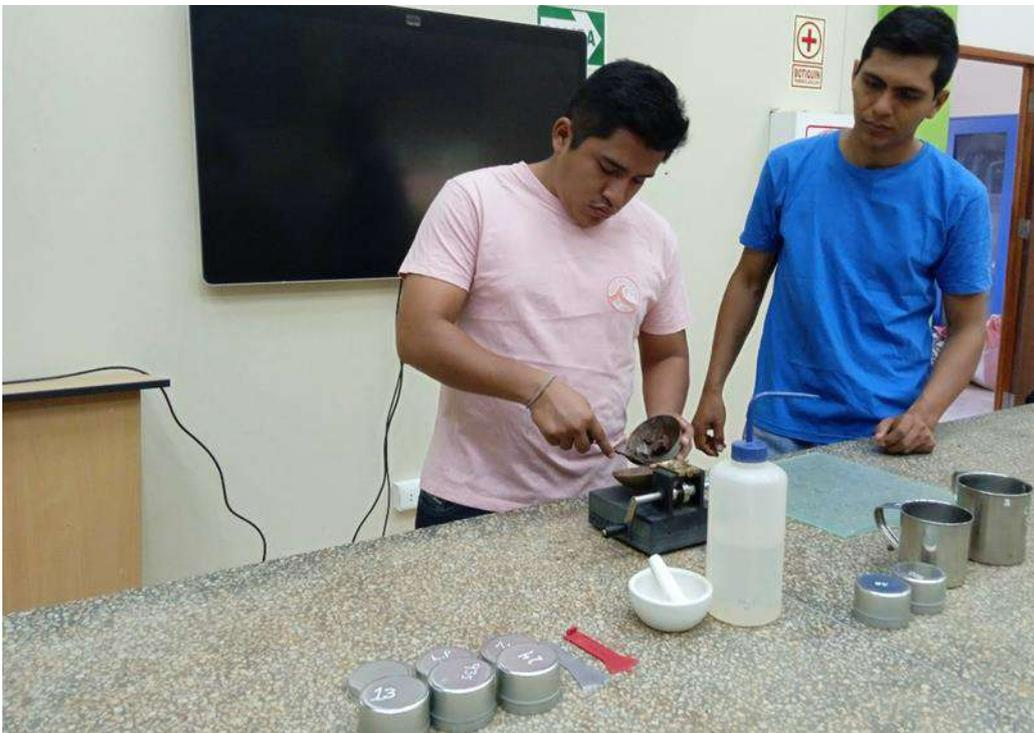
**Fotografía N° 06:** Se observa a los bachilleres realizando el ensayo de limite liquido en la copa de Casagrande
