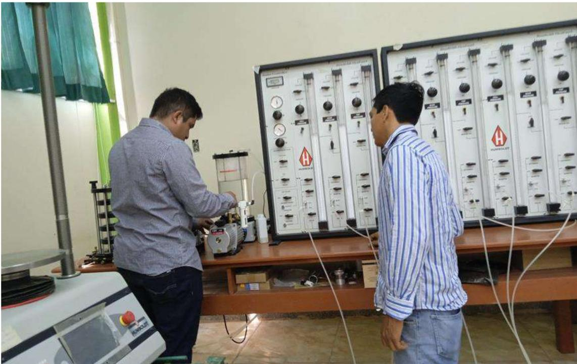
**Fotografía N° 08:** Se observa a los bachilleres realizando el ensayo de Carga Triaxial No Consolidado
