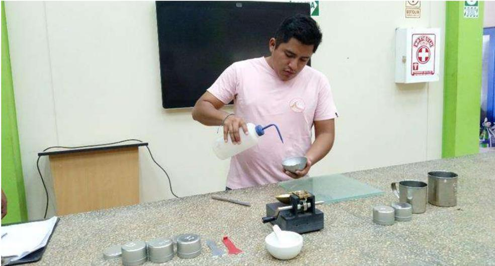
**Fotografía N° 05:** Se observa al bachiller colocando agua en la tara con un poco de muestra de suelo para empezar el ensayo de limite liquido y plástico.
