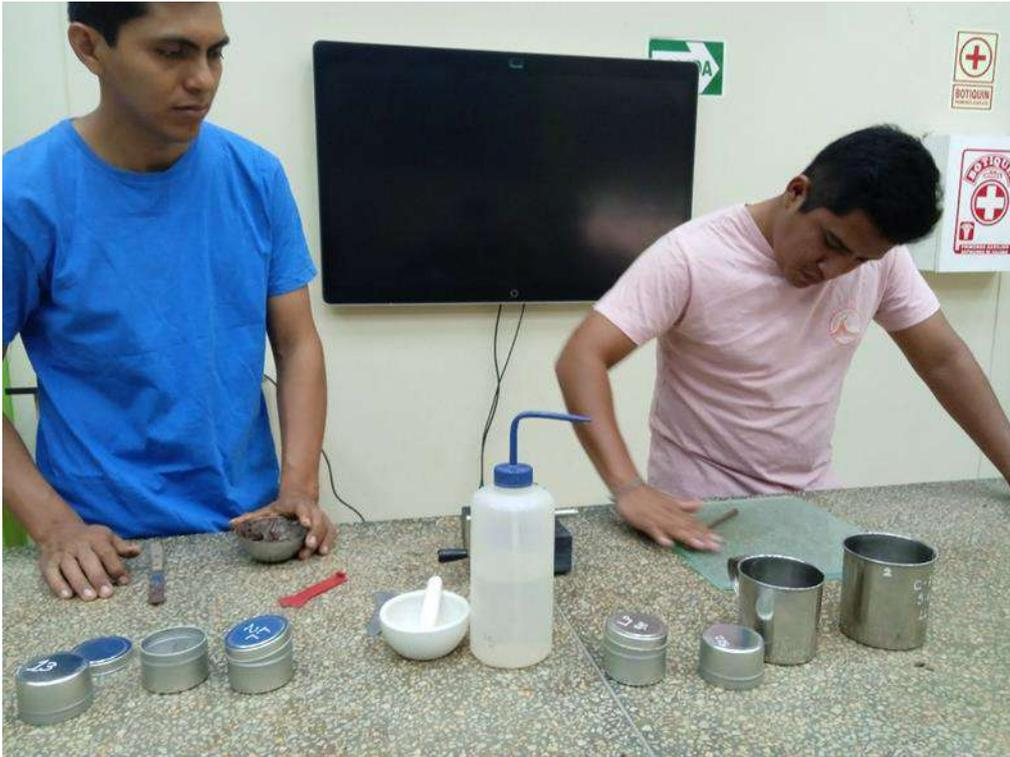
**Fotografía N° 07:** Se observa a los bachilleres realizando el ensayo de limite plástico, hasta obtener la forma cónica de 3 mm
