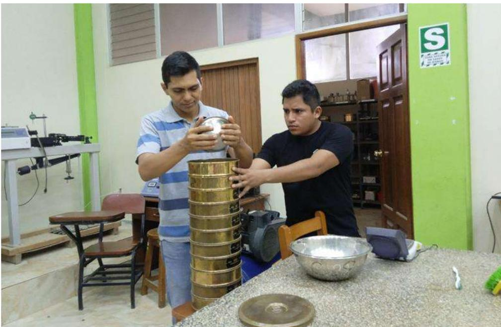
**Fotografía N° 04:** Se observa a los bachilleres colocando la muestra de suelo en los juegos de tamices, para su posterior zarandeo mecánico por unos minutos.
