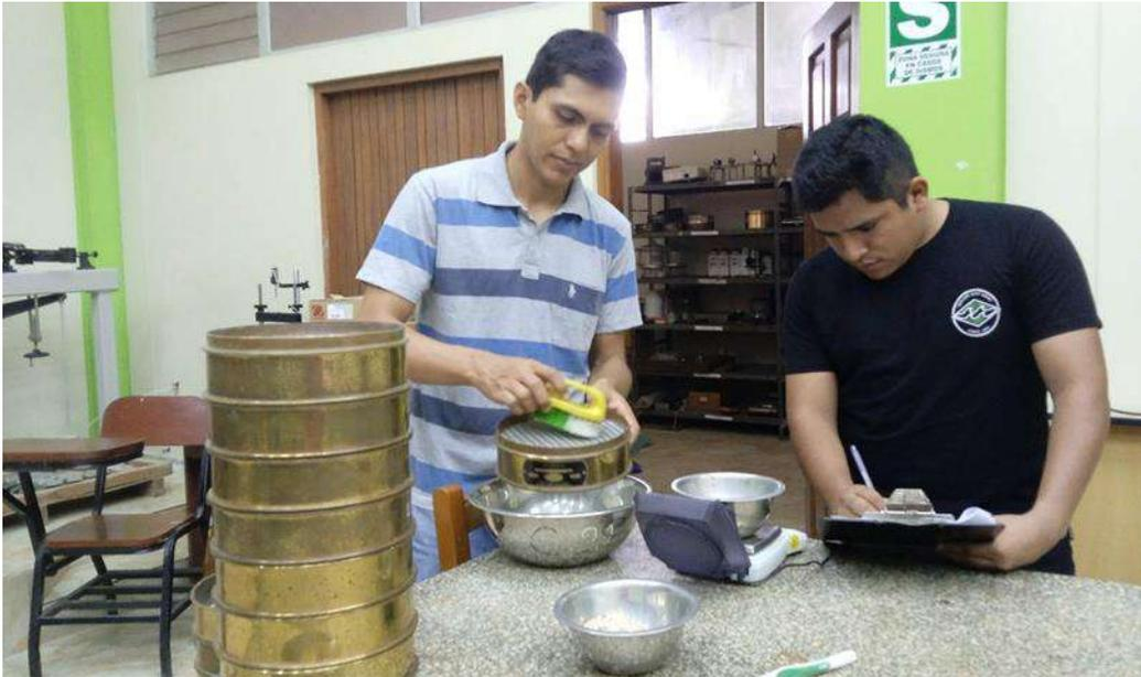
**Fotografía N° 03:** Se observa a los bachilleres recolectando la muestra de suelo y Tomando apuntes del peso retenido en cada uno de los tamices usados.
