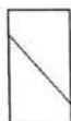
Tipo 4 Fractura diagonal sin fisuras a través de los extremos; golpeo suavemente con un martillo para distinguirla del Tipo 1
