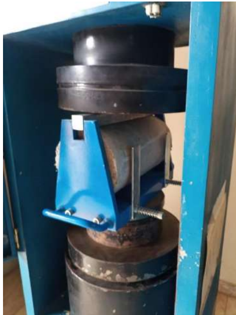
Foto 7: Rotura a tracción indirecta del concreto.
