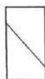
Tipo 4 Fractura diagonal sin fisuras a través de los extremos; golpeado suavemente con un martillo para distinguirla del Tipo 1
