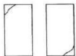
Tipo 5 Fracturas en los lados en las partes superior o inferior (ocurre comúnmente con cabezales no adheridos)
