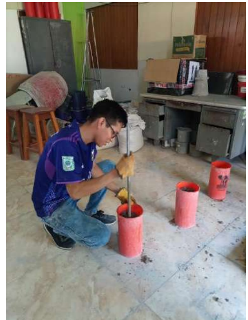
Foto 4: Procedimiento de varillado a las probetas.
