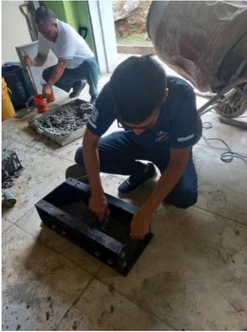
Foto 5: Procedimiento de llenado a las vigas con diferentes porcentajes de fibras.
