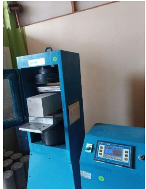
Foto 8: Rotura a flexión del concreto.
