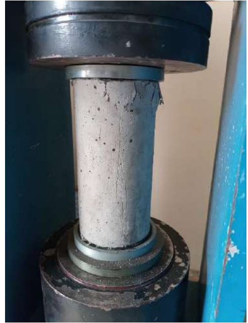
Foto 6: Rotura de testigo a compresión.
