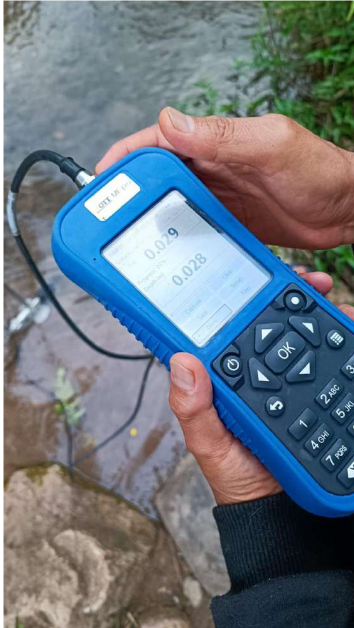
Imagen 5 Vista fotográfica del equipo que mide el caudal
