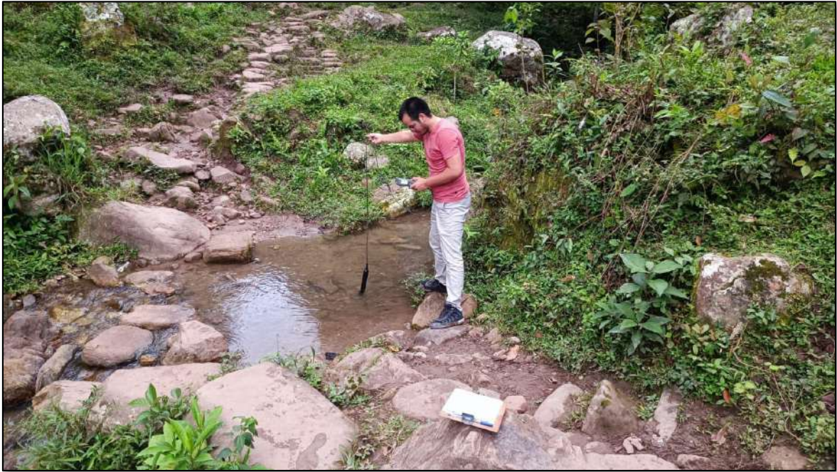
Imagen 3 Medición de caudal in situ, parte alta de la cuenca
