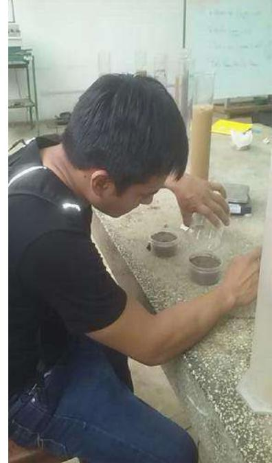
**Fotografía N° 08:** ENSAYOS DE LIMITES DE CONSISTENCIA
