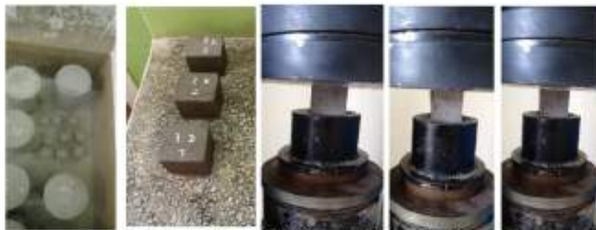
Fotografía N°11. Ensayo de compresión de cubos.
