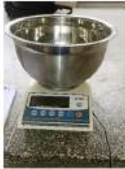
Fotografía N°6. Ensayo de contenido de humedad.
