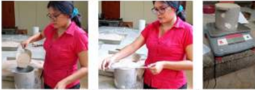
Fotografía N°9. Ensayo de peso unitario suelto.
