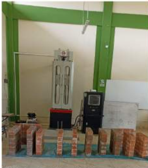
Fotografía N°13. Muros de albañilería adheridos con Massa DunDun y mortero tradicional.
