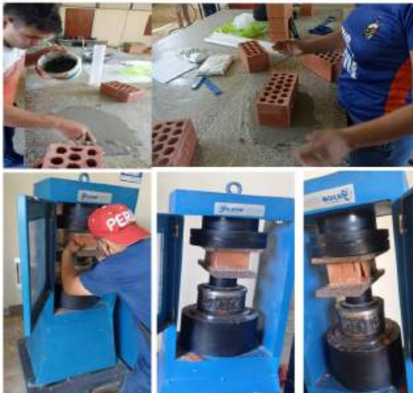
Fotografía N°5. Ensayo de compresión de las unidades de la unidad de albañería.
