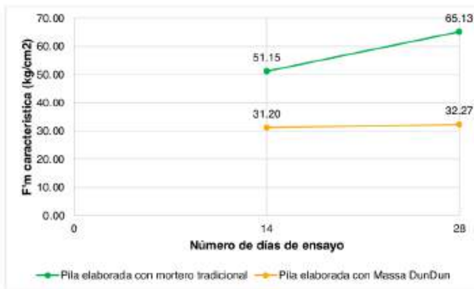
Figura 8 Resistencias características alcanzadas por pilas de albañilería. Fuente: Elaboración propia.
