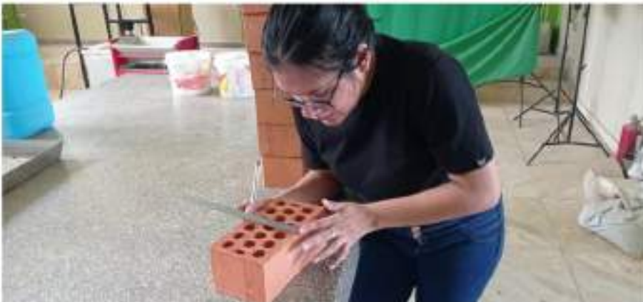
Fotografía N°2. Ensayo de variabilidad dimensional de la unidad de albañería.
