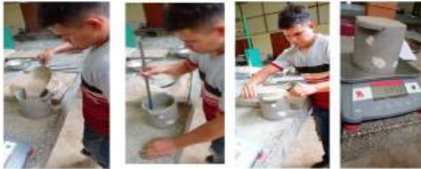
Fotografía N°10. Ensayo de peso unitario compactado.
