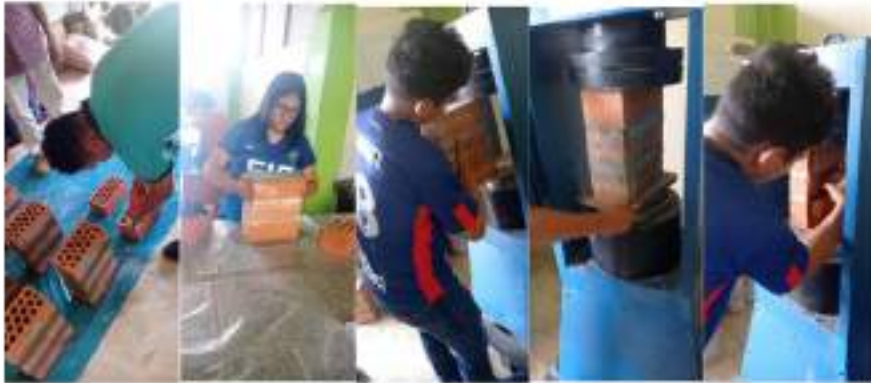
Fotografía N°12. Ensayo a Compresión en Pilas de albañilería.
