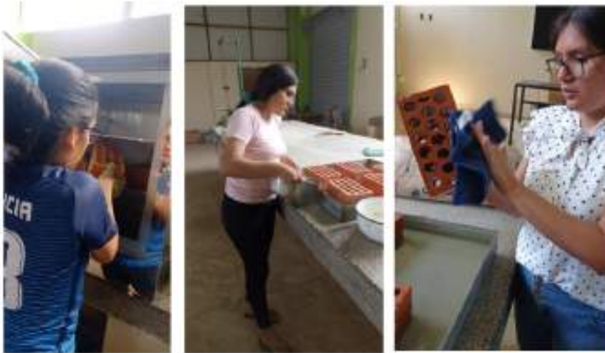
Fotografía N°4. Ensayo de Absorción de la unidad de albañería.
