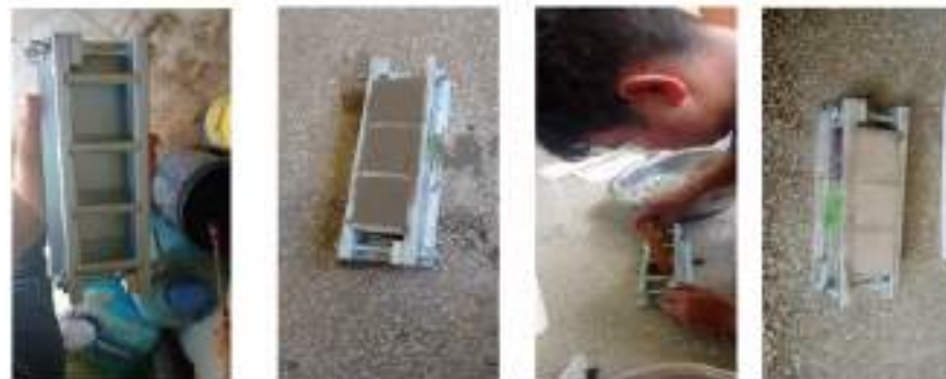
Fotografía N°10. Ensayo de peso unitario compactado.
