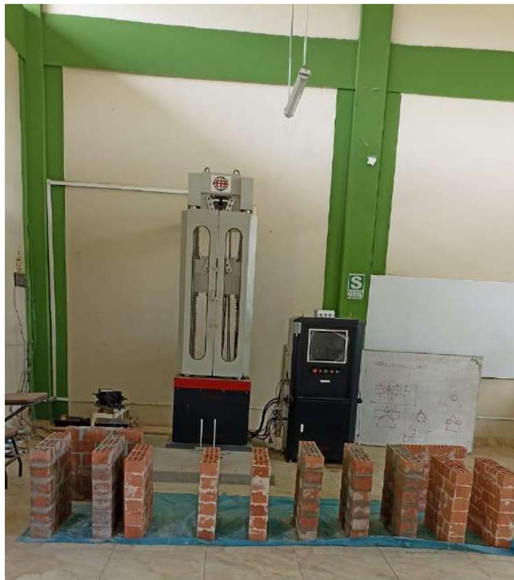
**Fotografía N°13. Muros de albañilería adheridos con Massa DunDun y mortero tradicional.**
