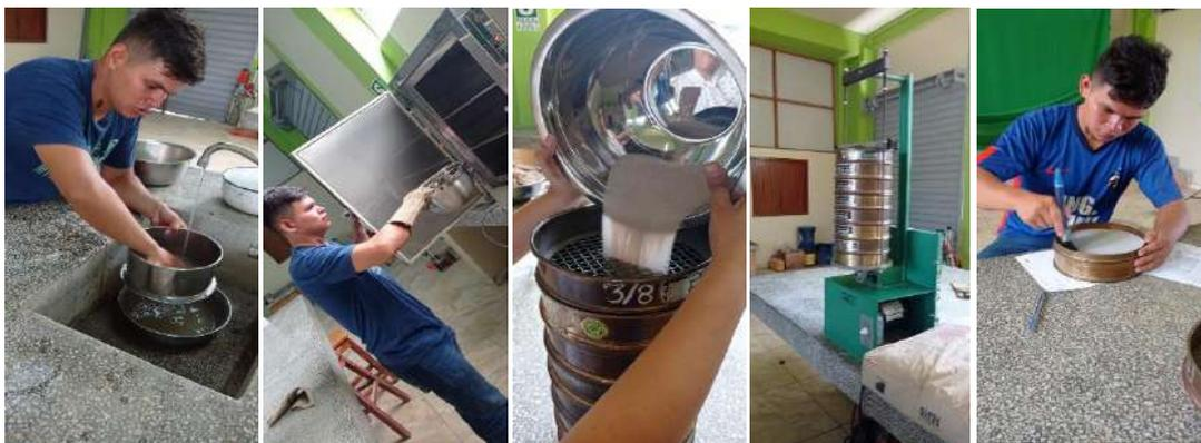
Fotografía N°8. Ensayo de granulometría.
