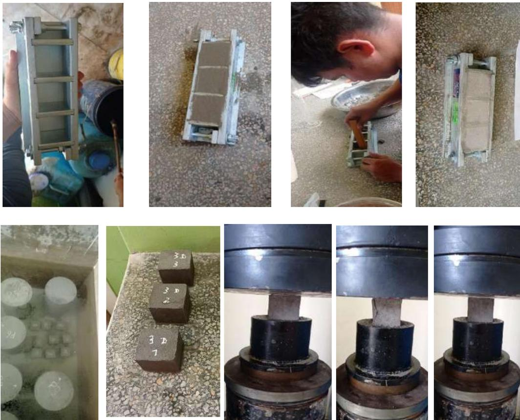
Fotografía N°11. Ensayo de compresión de cubos.
