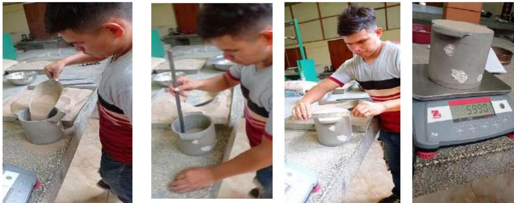
Fotografía N°10. Ensayo de peso unitario compactado.
