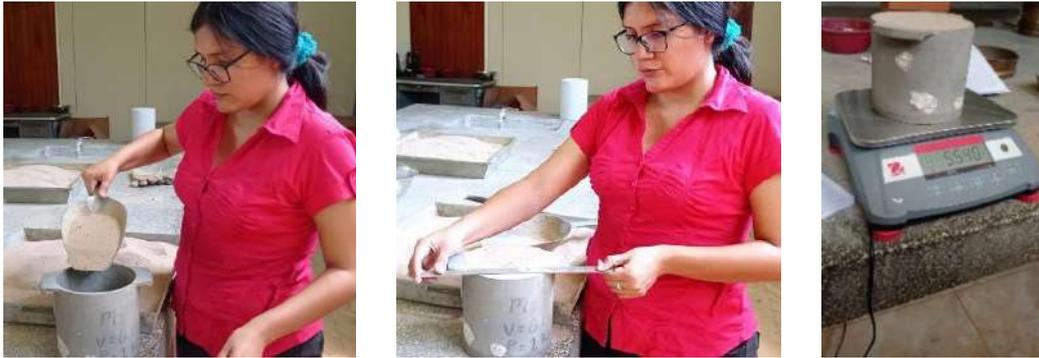
Fotografía N°9. Ensayo de peso unitario suelto.
