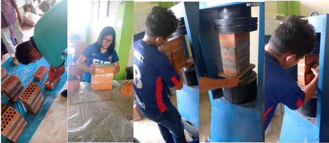
**Fotografía N°12. Ensayo a Compresión en Pilas de albañilería.**
