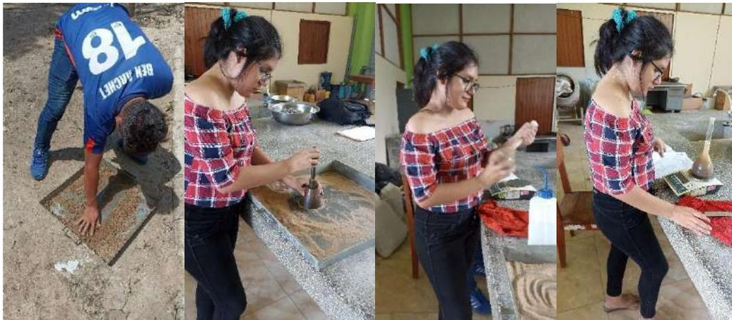
Fotografía N°7. Ensayo de peso específico y absorción.
