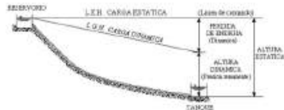
Figura 7. Perfil de la Línea de conducción
