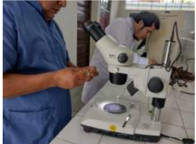
Fotografía 2: Estéreo microscopio - MOTIC - SMZ-171 TLED(ESD) para ampliar las observaciones.
