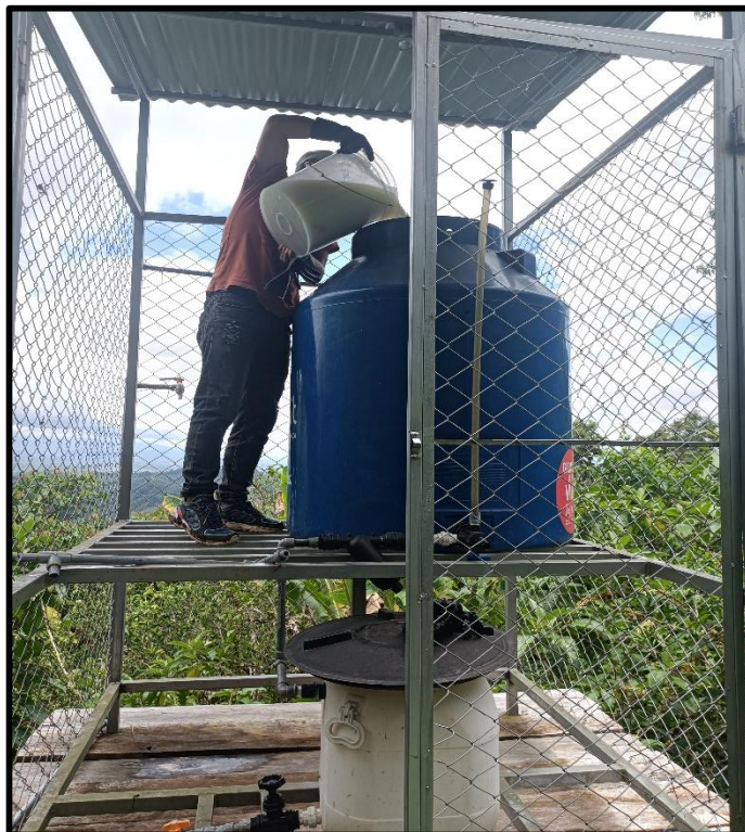
Fotografía N° 6. Muestreo de cloro residual en el reservorio con equipo DR900.
