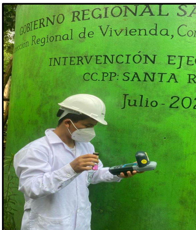
Fotografía N° 6. Muestreo de cloro residual en el reservorio con equipo DR900.
