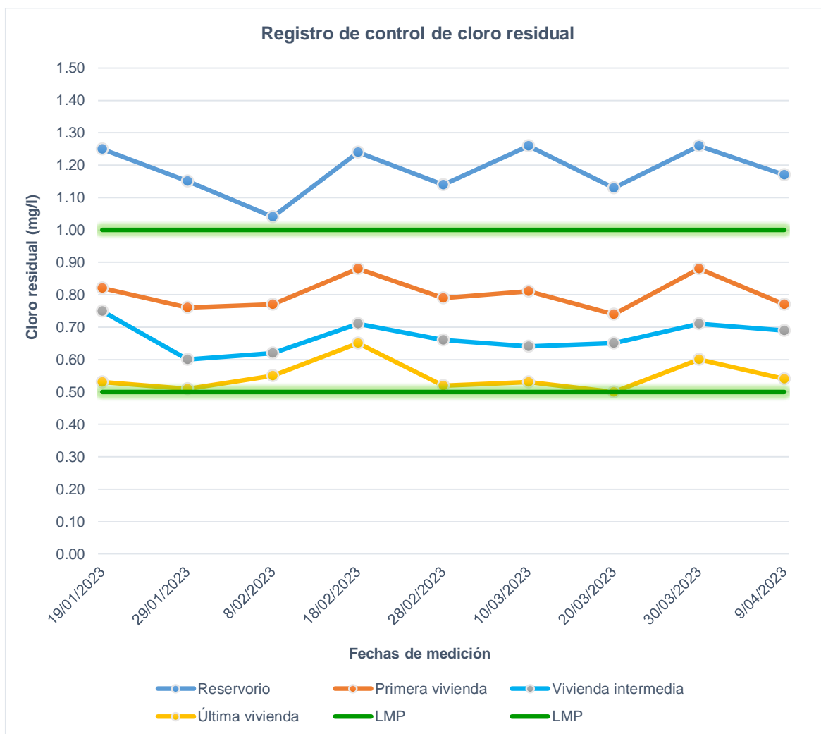
Figura 7. Registro de control de cloro residual
