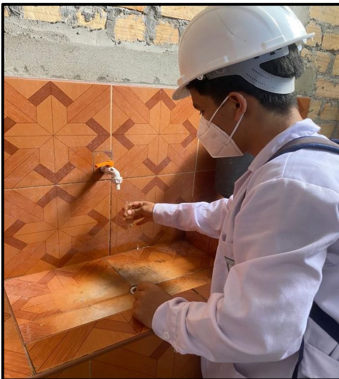
Fotografía N° 10. Toma de muestra para medir el cloro residual en la vivienda intermedia.
