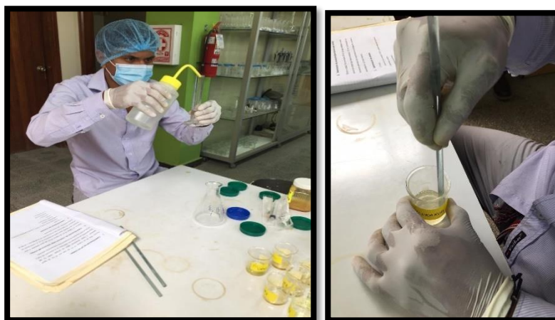
Figura 7. Preparación de muestras de miel de Tetragonisca sp para la prueba de pH y conductividad eléctrica.
