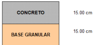
Figura 17. Grosor del pavimento rígido
