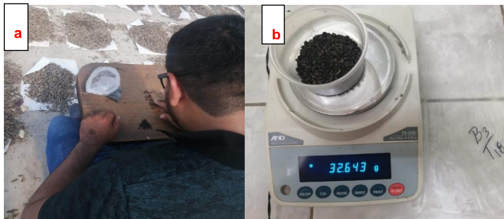
Figura 6. Peso de 1000 semillas. A Separación de semillas de C.juncea de acuerdo al estado fitosanitario. B Pesado de 1000 semillas de C.juncea en una balanza de laboratorio digital.
