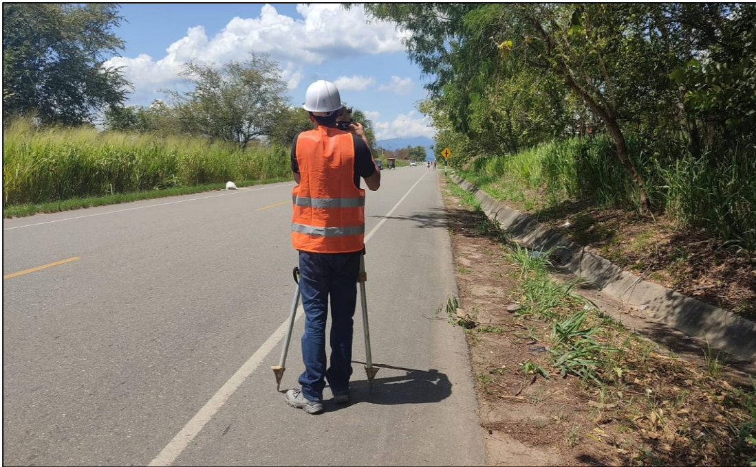
Figura 31. Recolección de datos con mira y nivel Tramo 2 (5+500 KM - 5+820 KM). Fuente: Elaboración propia.
