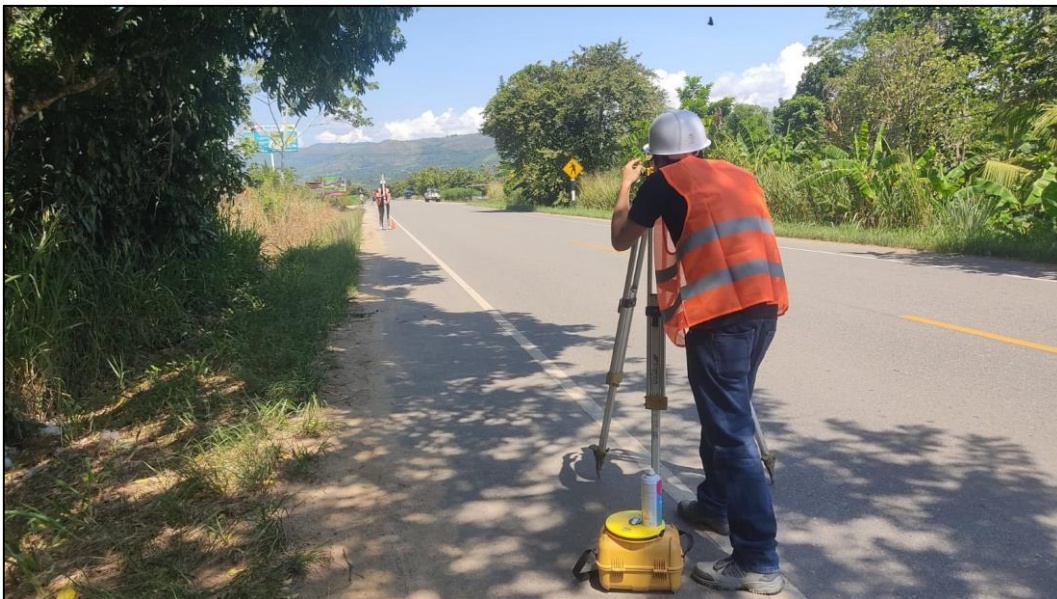
Figura 29. Recolección de datos con mira y nivel Tramo 1 (2+000 KM - 2+320 KM). Fuente: Elaboración propia.
