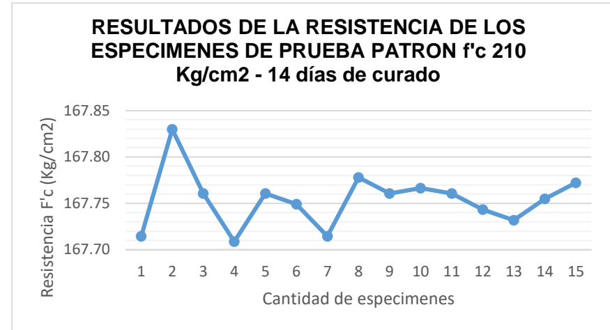
Figura 8. Resumen de resultados de rotura Muestra patrón F’c= 210Kg/cm 2 – 14 días curado Fuente: Elaboración propia.
