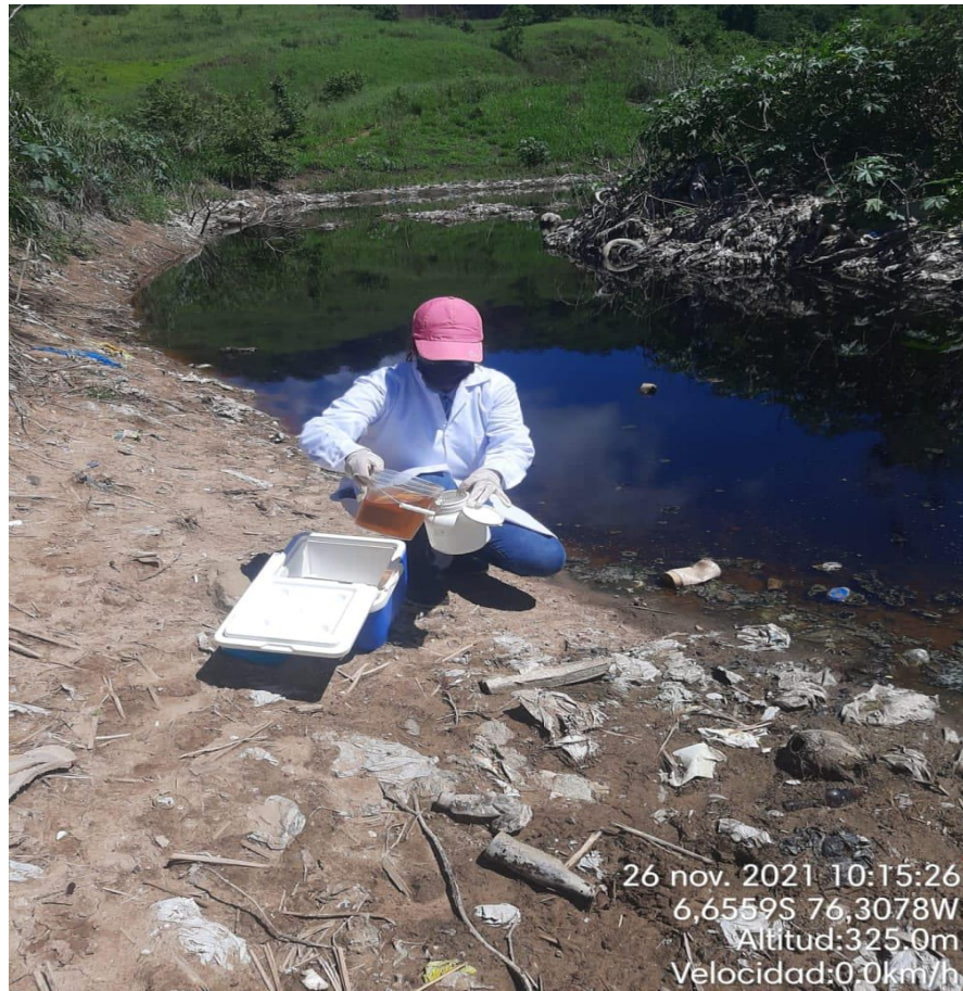
Foto 3. Homogenización de las muestras de lixiviados
