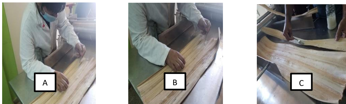
Figura 21. Engomado capa por capa usando goma de arroz (A), goma de arroz +10% resina(B) y control (C).
