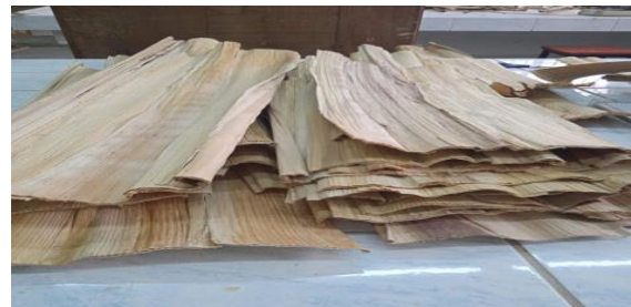
f. Incorporación del adhesivo (Sintético, natural de almidón de arroz y un combinado con resina del mismo corazón del Platanal).
