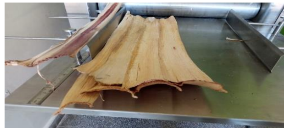
d. Capa del seudoallos seco y listo para la primera pasada a la laminadora de rodillos.
