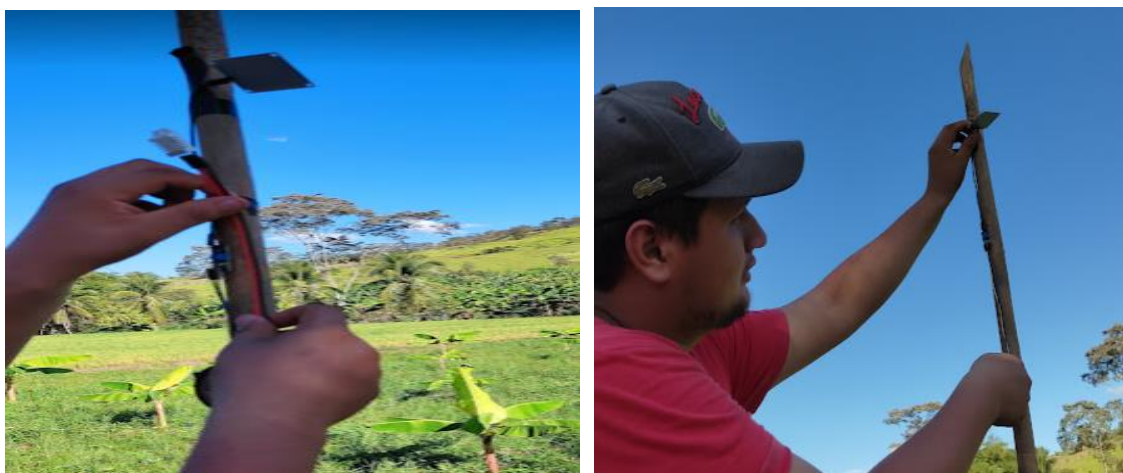
Figura 15. Instalación sensores FC-37 y DHT22 (AM2302)
