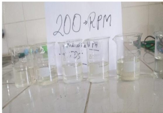
Vista fotográfica 24 del resultado de la prueba de jarra a la intensidad optima de 200 rpm; al 3%
