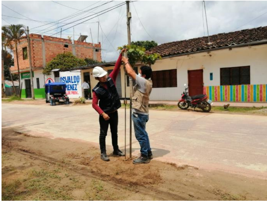
Figura 14. Foto de los golpes con el martillo en el equipo DCP. Fuente: Elaboración propia, (2022).
