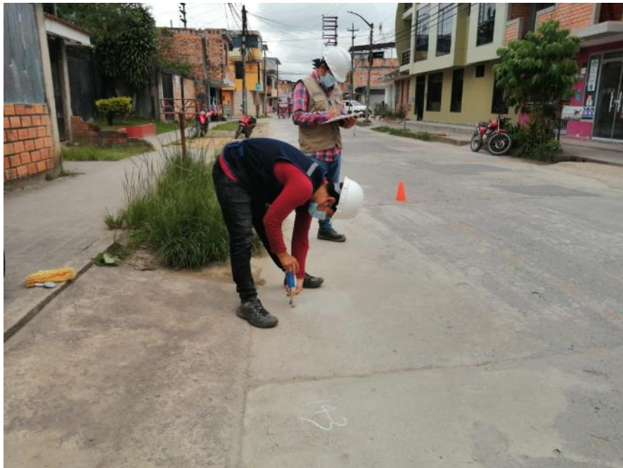
Figura 15. Foto del uso del equipo esclerómetro para la toma de datos del paño. Fuente: Elaboración propia, (2022).
