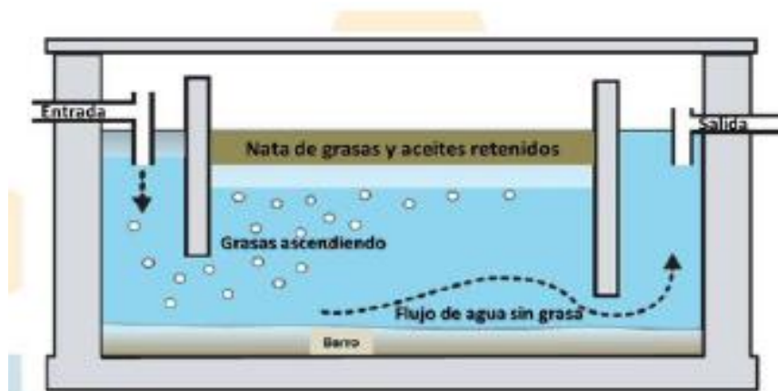
Figura 1. Trampa de grasa y aceites Fuente: (García y Estrada, 2016)
