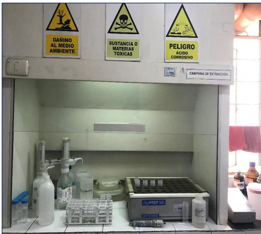
**Foto 16.** Disposición de los digitubos en la campana de extracción
