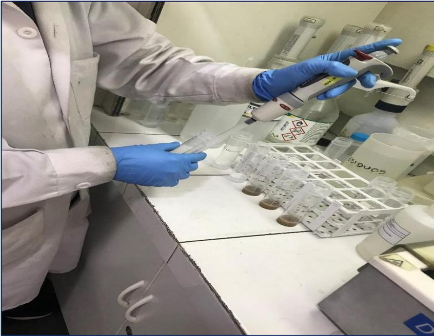
**Foto 17.** Adición de la solución de ácido nítrico a las muestras de suelo
