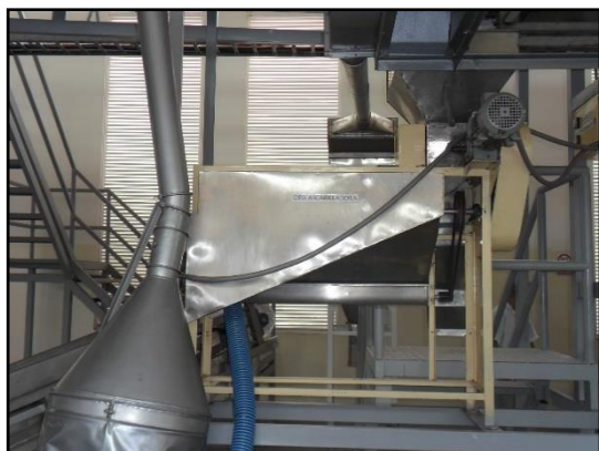
Figura 92: Descascarilladora de granos. (Fuente: Catálogo de maquinaria para el procesamiento del cacao,2018).
