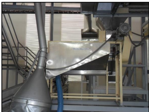
Figura 71: Descascarilladora de granos. (Fuente: Catalogo de maquinaria para el procesamiento del cacao,2018).
