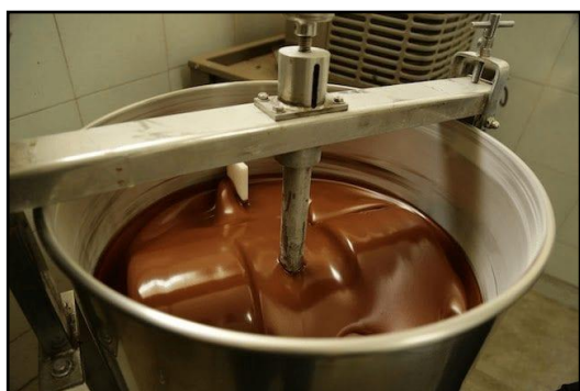
Figura 75: Conchadora de granos. (Fuente: Catálogo de maquinaria para el procesamiento de cacao,2018).
