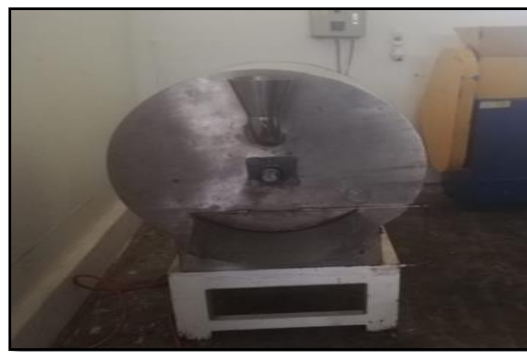
Figura 6. Maquina tostadora. (Fuente: Elaboración propia, visita de campo 2019).
