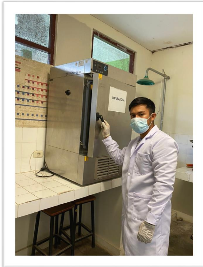
Fotografía 7. Analisis de DBO en la incubadora
