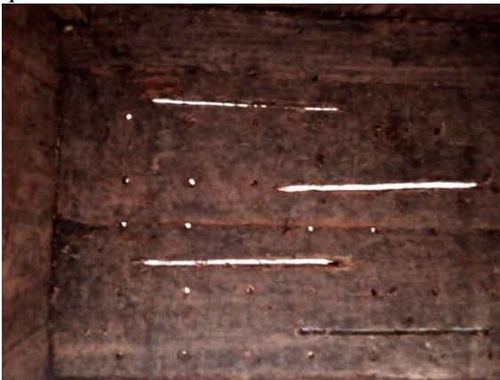
Orificios y ranuras en la base de los cajones fermentadores para el escurrido del cacao
