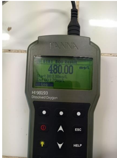
Fotografía 16. Medición de la DBO 5 del efluente.
