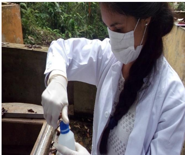
Fotografía 6. Toma de muestra en captación
