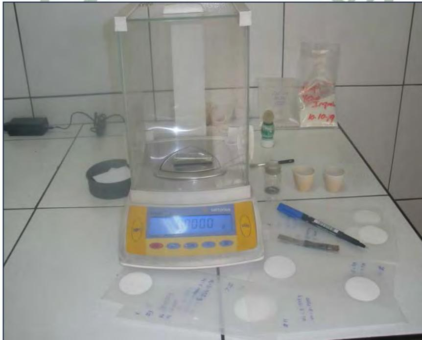
FOTOGRAFÍA N° 10. Filtro de monitoreo rotulados, laboratorio de la Planta de CSSA.
