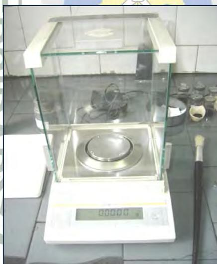
**FIGURA N° 07. Balanza analítica marca Sartorius modelo BP3015.**
