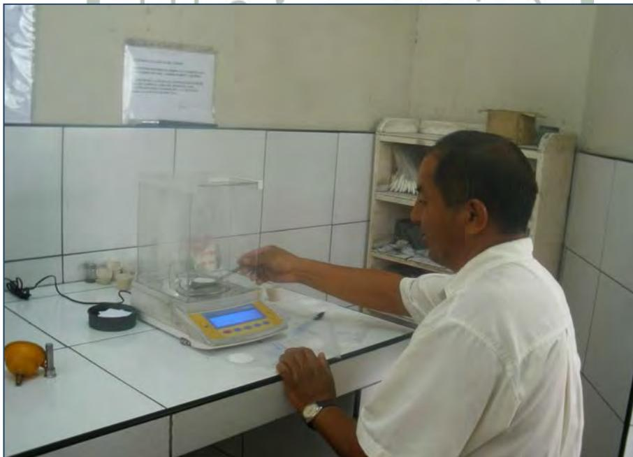
FOTOGRAFÍA N° 03. Realizando el pesado del filtro para monitoreo en el laboratorio de la Planta de CSSA.
