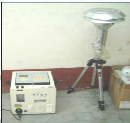
**FIGURA N° 06. Equipo de monitoreo automático tipo: Low Vol PM10 Bravo M Plus TCR.**
