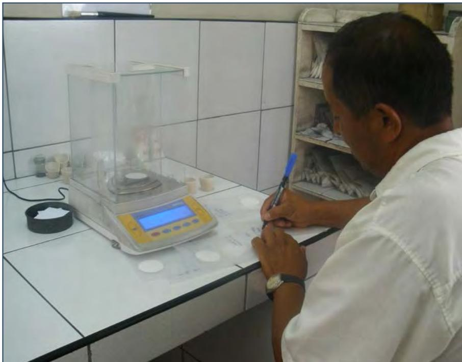
FOTOGRAFÍA N° 04. Rotulado de filtro para monitoreo, laboratorio de la Planta de CSSA.
