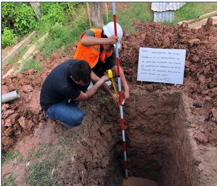
**Figura 58:** Medición del nivel freático en calicata C-02. (Fuente: Elaboración Propia).
