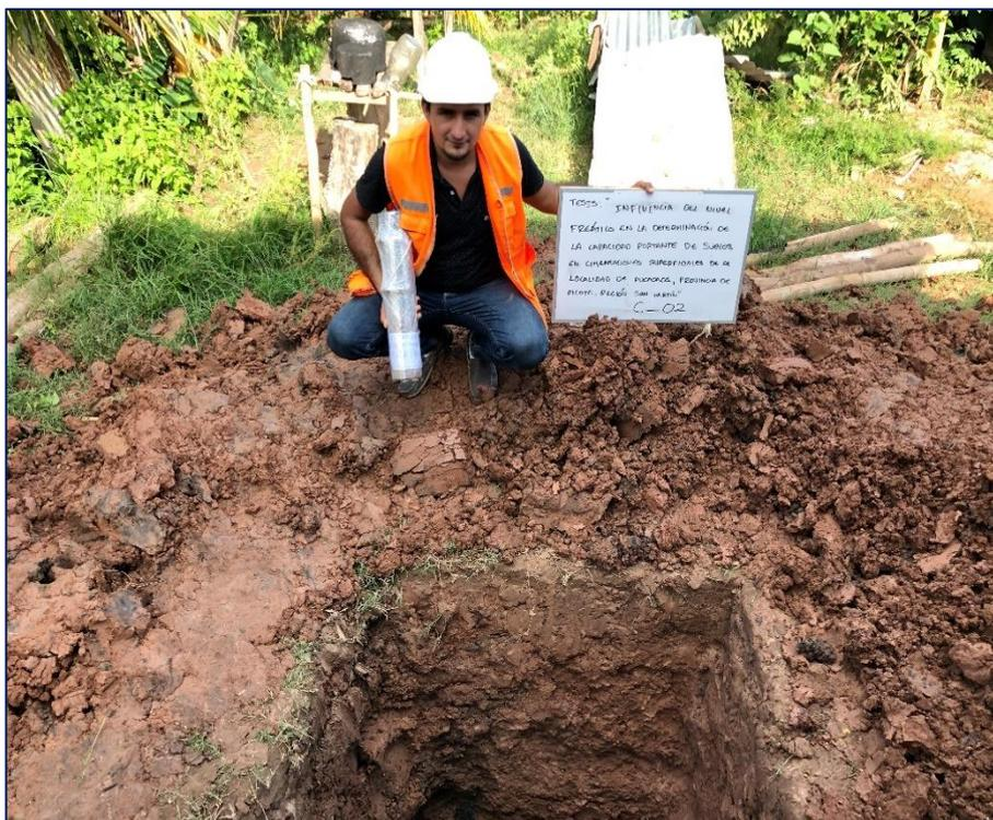
**Figura 60:** Protección de muestra para transporte a laboratorio. (Fuente: Elaboración Propia).
