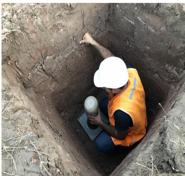
**Figura 31:** Ensayo insitu de densidad de campo. (Fuente: Elaboración propia)
