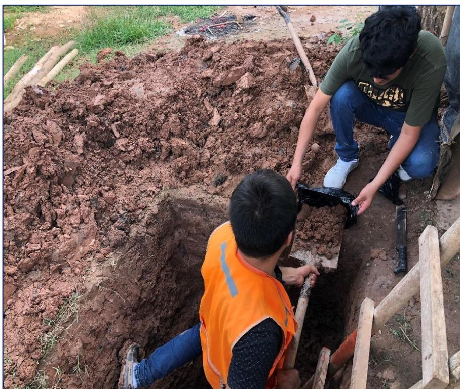
**Figura 61:** Extracción de muestra para obtención de granulometría. (Fuente: Elaboración Propia)
