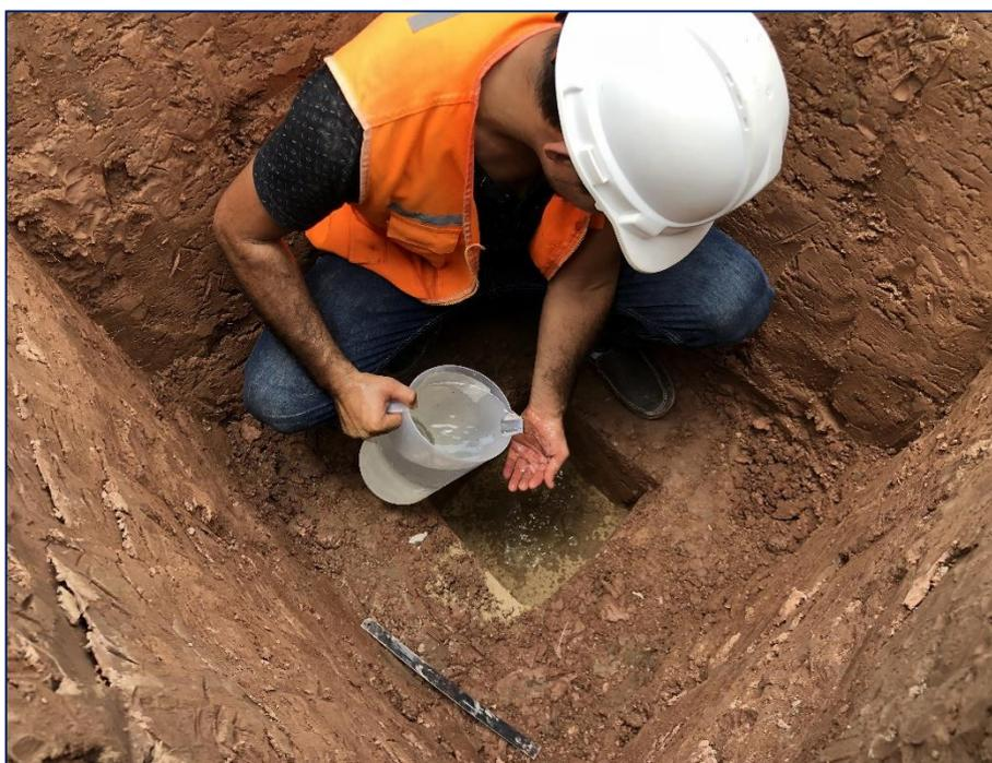
**Figura 57:** Colocación de agua potable para ensayo de percolación. (Fuente: Elaboración Propia).
