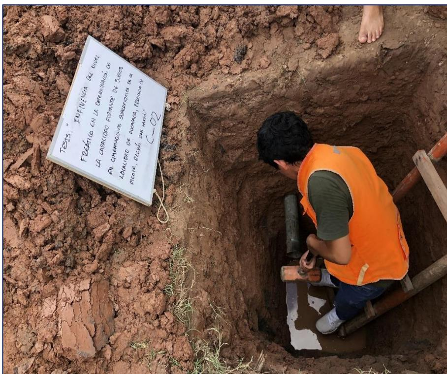
**Figura 59:** Extracción de muestra para ensayo de corte directo. (Fuente: Elaboración Propia)
