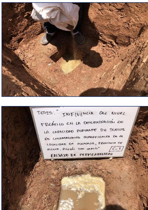
**Figura 33:** Ensayo insitu de Infiltración y permeabilidad. (Fuente: Elaboración propia)
