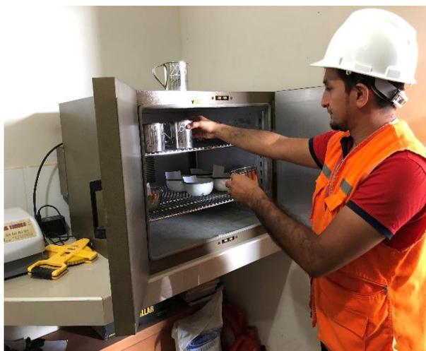
**Figura 34:** Colocación de muestras de suelo en horno de secado. (Fuente: Elaboración propia)
