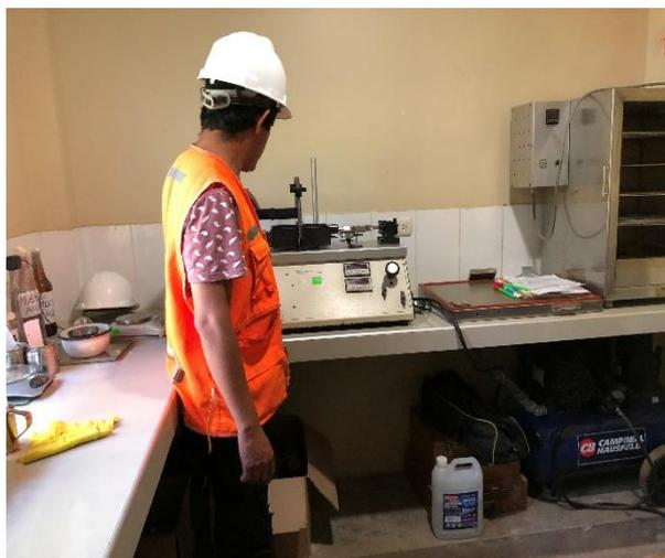
**Figura 40:** Ensayo de corte directo. (Fuente: Elaboración propia)
