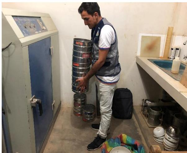
**Figura 35:** Ensayo de clasificación granulométrica del suelo. (Fuente: Elaboración propia).
