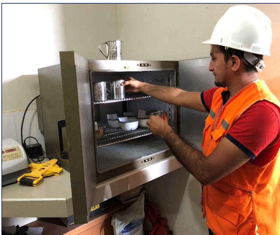
**Figura 63:** Colocación de muestras en horno de secado. (Fuente: Elaboración Propia).
