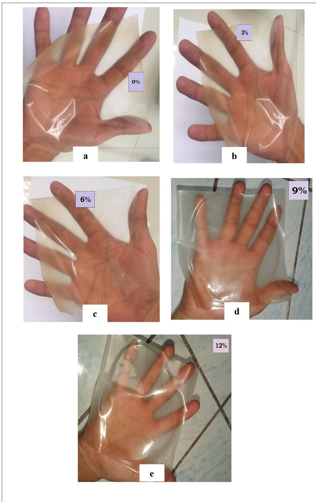
**Figura 14.** Fotografías de las películas obtenidas a partir de las mezclas PVOH con APSI a. 0% de PVOH, b. 3% de PVOH, c. 6% de PVOH, d. 9% de PVOH, e. 12% de PVOH.
