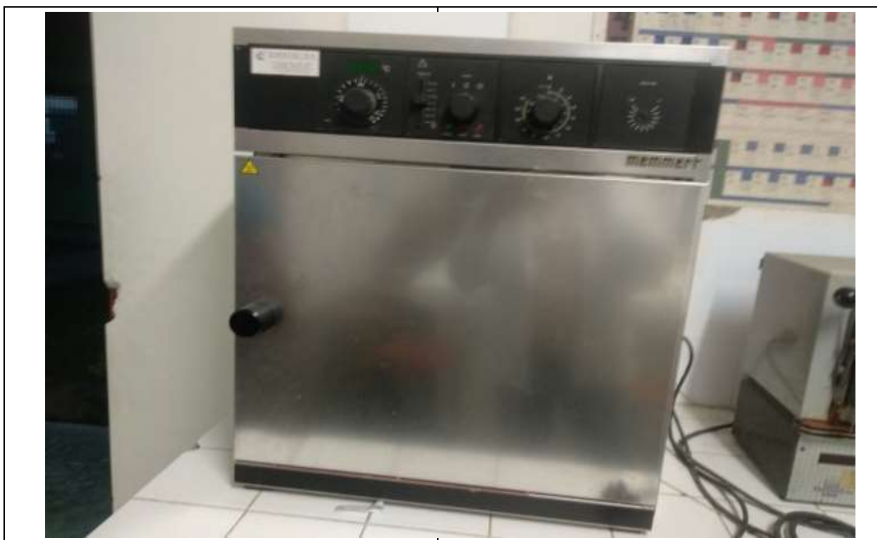
Fotografía 12. Estufa. (Fuente: Foto tomada por el tesista).
