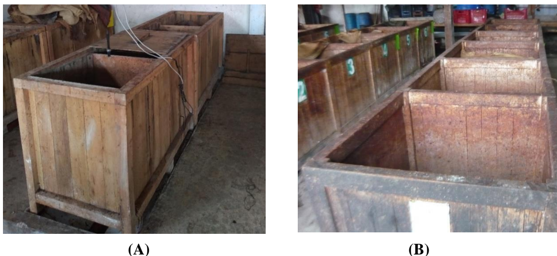
Figura 2. Cajones fermentadores sin aislamiento térmico. (A) Cajones de 150 Kg (B) Cajones de 500 Kg
