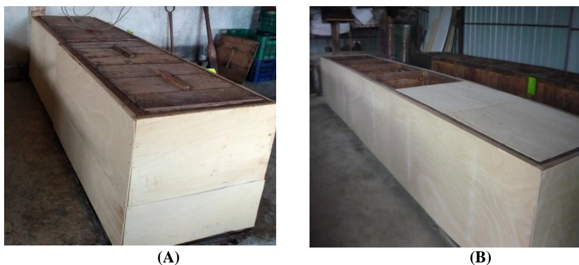
Figura 3. Cajones fermentadores con aislamiento térmico. (A) Cajones de 150 Kg (B)Cajones de 500 Kg
