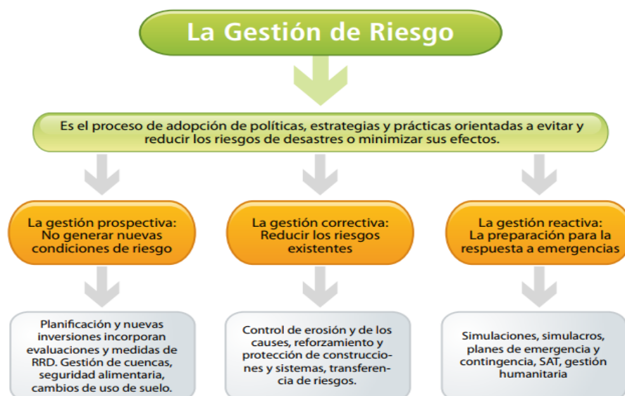
Figura 5. Componentes de la gestión de riesgo. Según la figura se puede distinguir de manera clara los diversos tipos de clasificación de la gestión de riesgos, la cual tenemos la prospectiva, correctiva y reactiva. (INDECI 2013).
