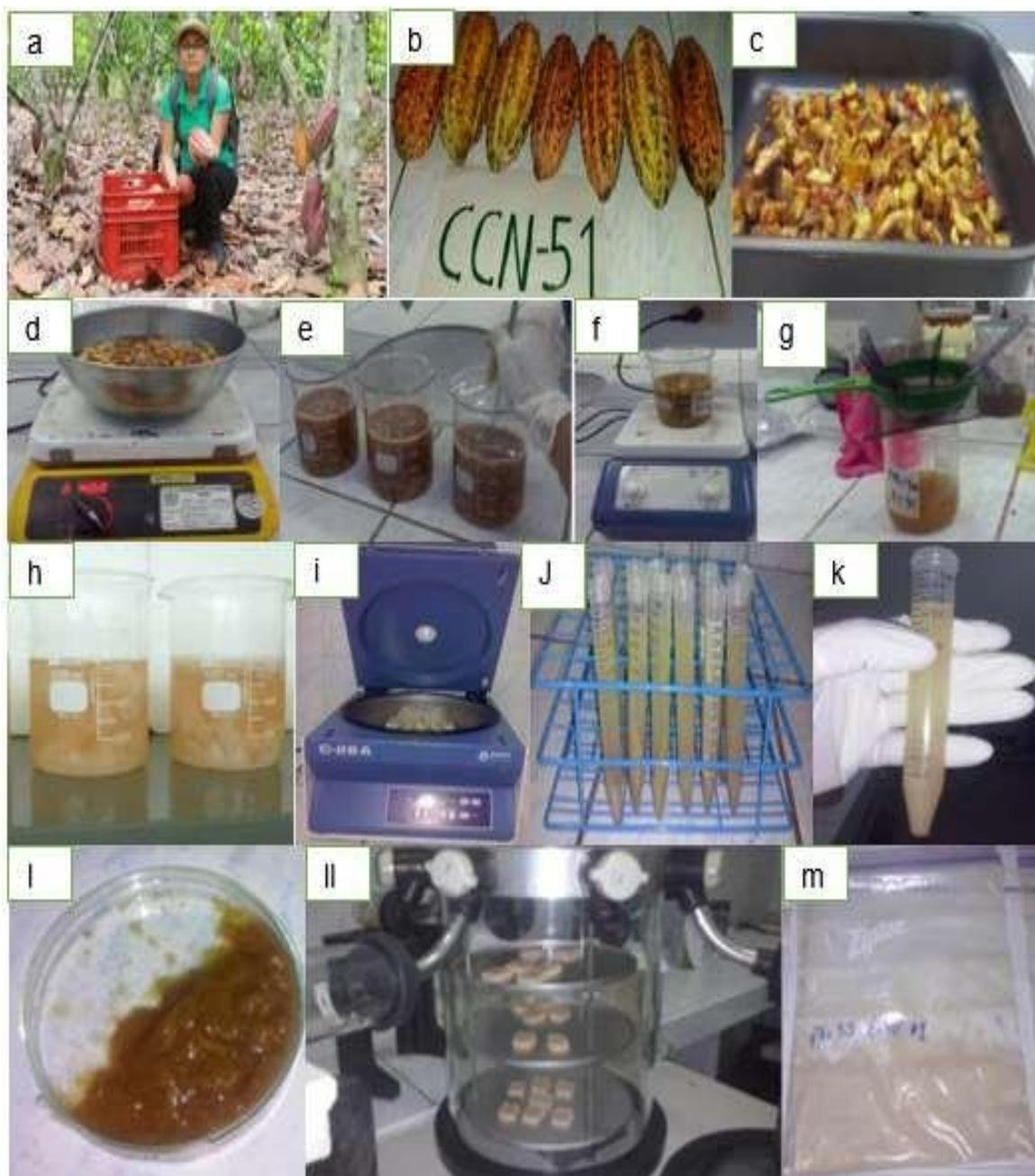
a) Recolección del fruto, b) Separación del fruto en buen estado, c) Picado de la cáscara de cacao, d) Inactivación de enzimas, e) Fijación de los pH a trabajar, f) Realiza la hidrólisis, g) Separación del gel y desechos sólidos. h) Precipitación de la pectina, i) Centrifugadora. J) Tubos recién salidos de la centrifugadora conteniendo la pectina. k) Muestra de un tubo con la pectina separada del líquido. l) Pectina en gel. ll) Puestas dentro del liofilizador. m) Pectina ya en polvo.
