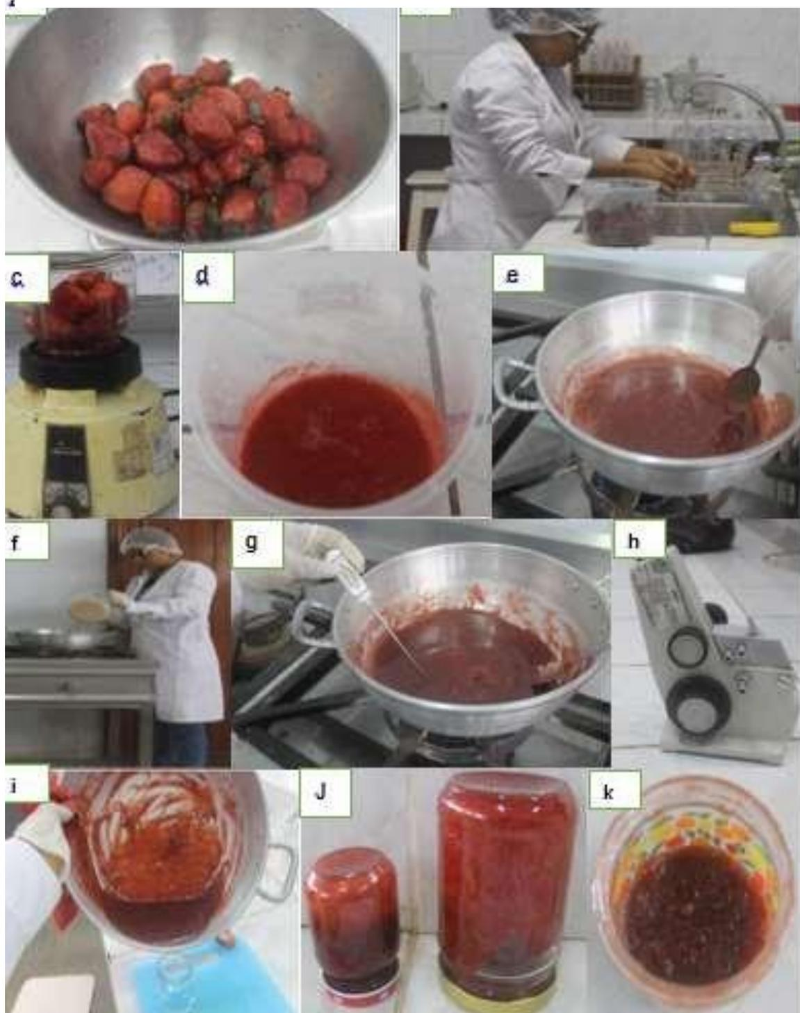
a) Fruta fresca. b) Lavado de la fruta. c) Triturado de la fruta. d) licuado de la fresa. e) Adición del jugo de fresa y del concentrado. f) Adición de la pectina. g) medición de la temperatura óptima. h) medición con el refractómetro. i) Envasado. j) Enfriado. k) Producto Final.
