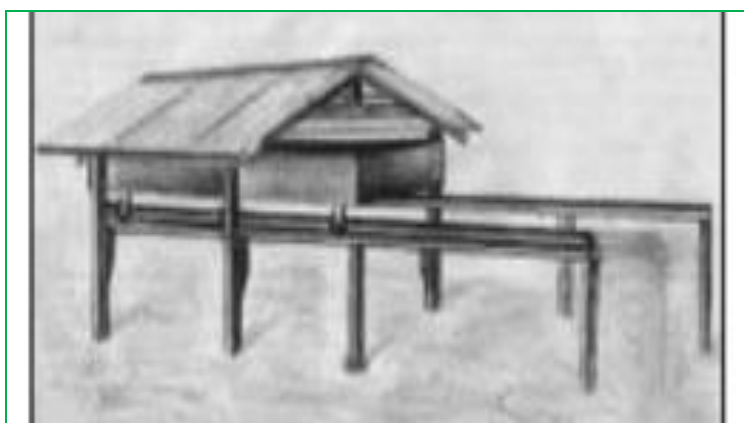
Figura 53: Secador de cacao con gaveta corrediza.
