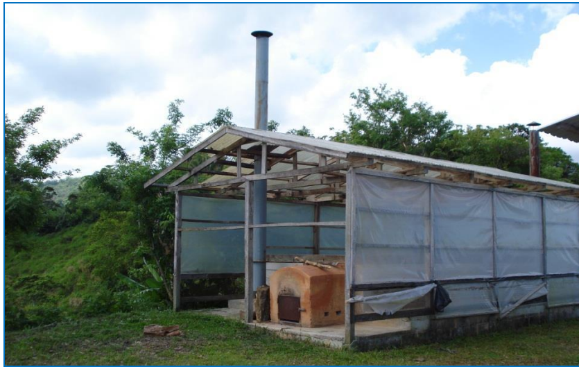
Figura 66-A: Secador artificial de cacao en base a leña.
