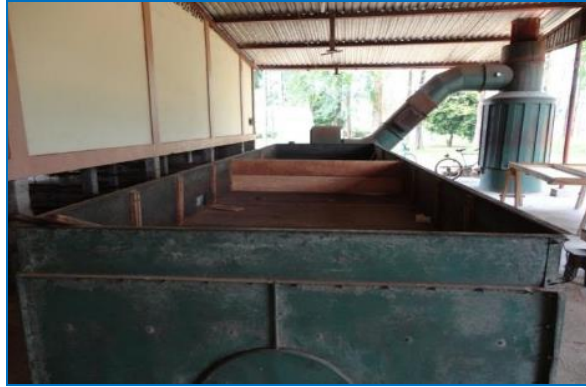
Figura 65: Secador artificial de cacao en base a leña.
