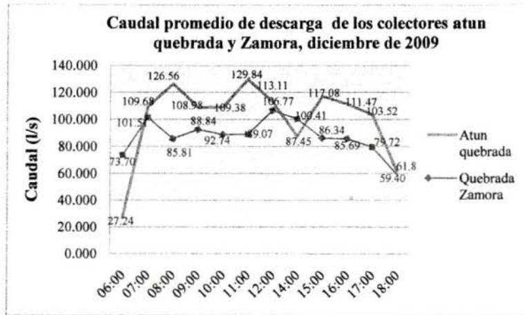
Gráfico N° 17: Caudal promedio de descarga de los colectores Atun quebrada y Zamora, desde las 6 horas hasta las 18 horas, diciembre 2009.
