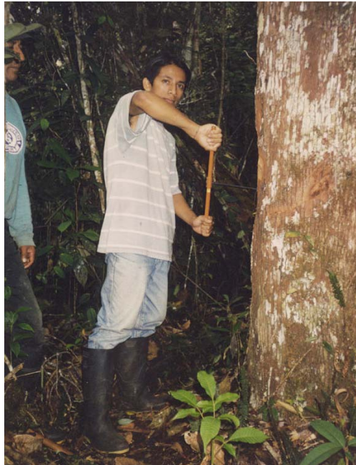
Foto N° 05: Extracción de muestras con barreno de Pressler
