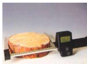
Medidor para conteo de anillos
