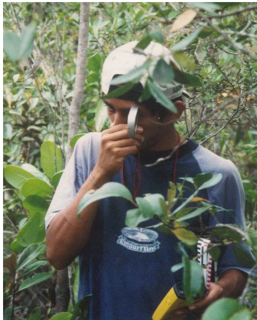
Foto N° 06: Determinación de alturas de árboles con clinómetro
