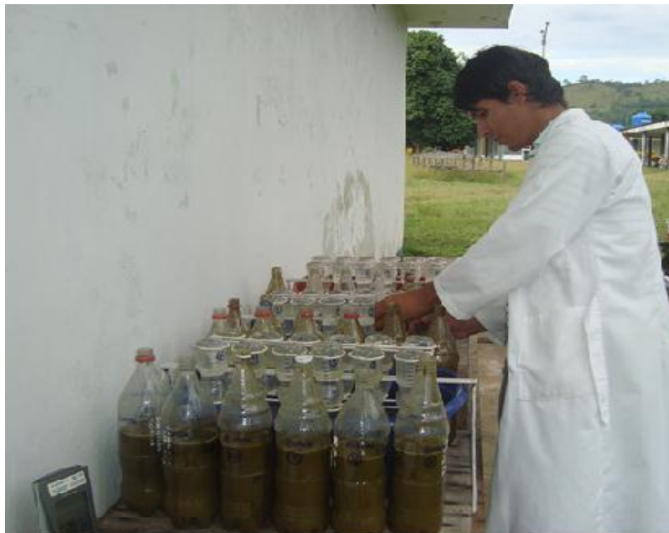
Colocación de los colectores (botellas descartables de 260ml) en los soportes de fierro.
