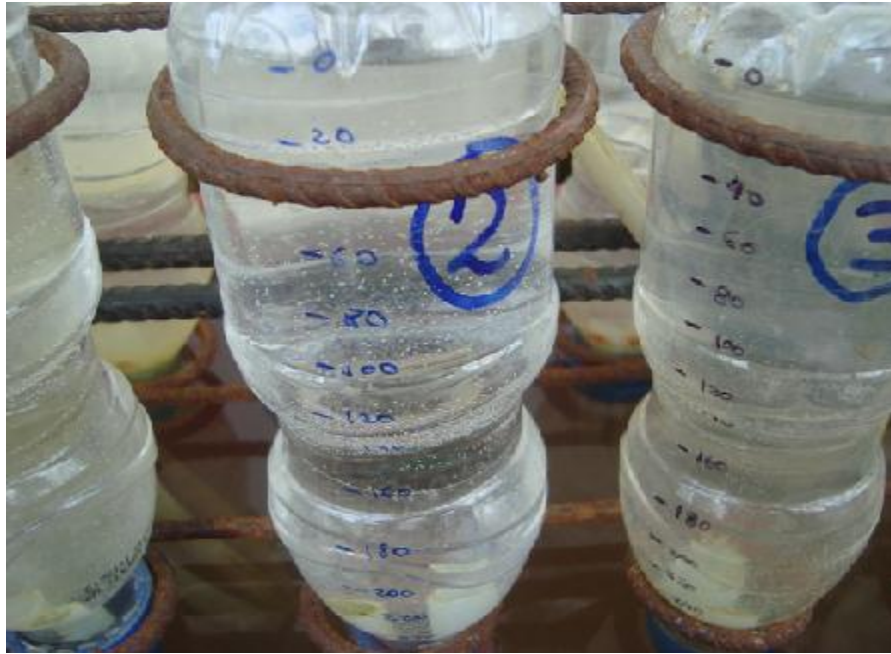
Colector de biogás debidamente calibrado produciendo burbujas de aire el cual es el biogás producido por el biodigestor.
