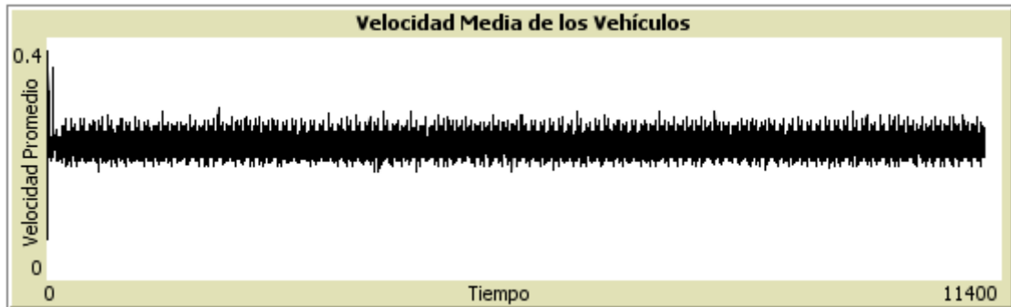
Figura N° 37: Gráfico de la velocidad media de los vehículos en la simulación del tráfico de urbano con Netlogo en 16 intersecciones del centro de Tarapoto en el año 2020.
