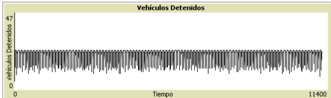
Figura N° 38: Gráfico de vehículos detenidos en la simulación del tráfico de urbano con Netlogo en 16 intersecciones del centro de Tarapoto en el año 2020.
