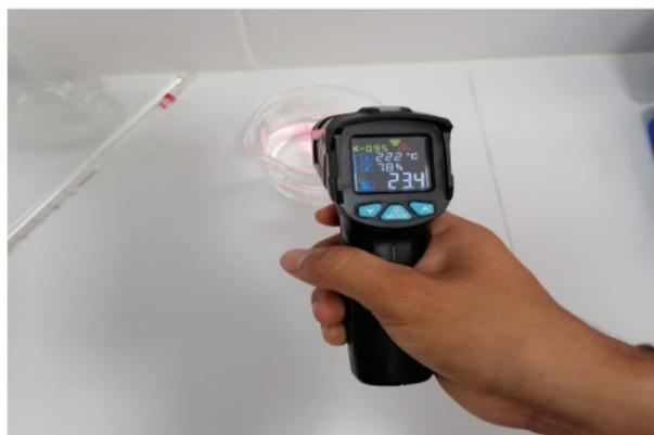
**Fotografía 5.** Medición de temperatura en muestra de agua cruda
