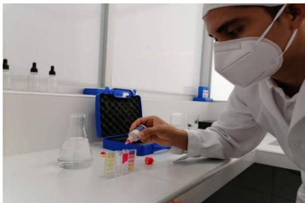
**Fotografía 4.** Medición de cloro residual en muestra de agua cruda
