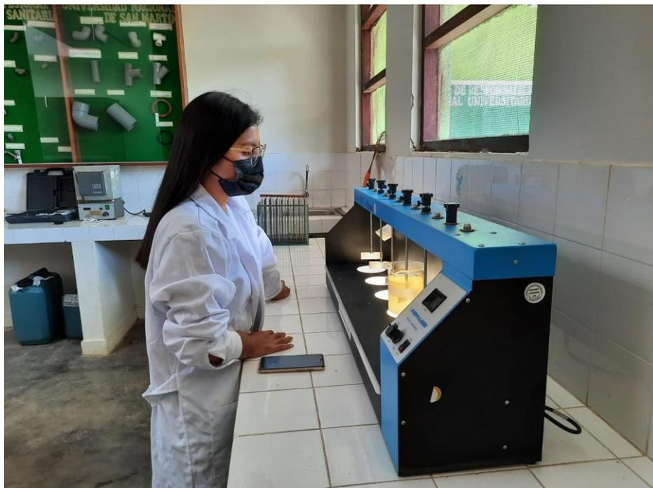
*Figura 16.* Ensayos de prueba de jarras
