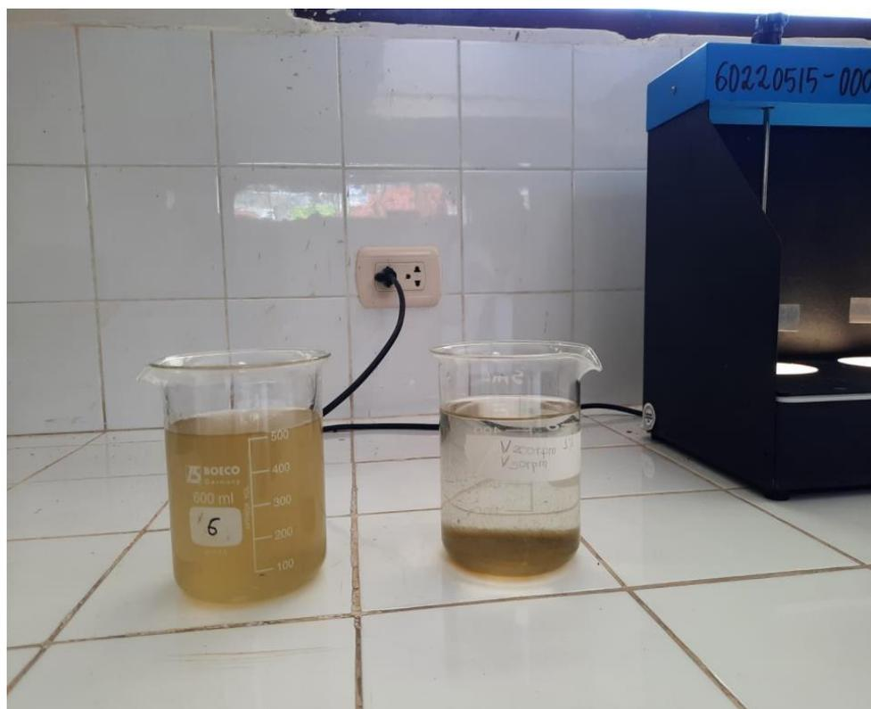
**Figura 17.** Resultados finales del proceso de tratamiento en la prueba de jarras
