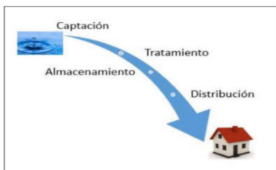
Figura 1. Proceso general de abastecimiento de agua potable
