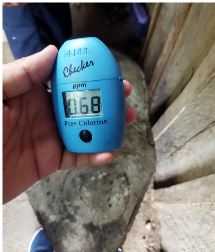
Fotografía 4. Resultado de muestra de cloro residual en PM-4
