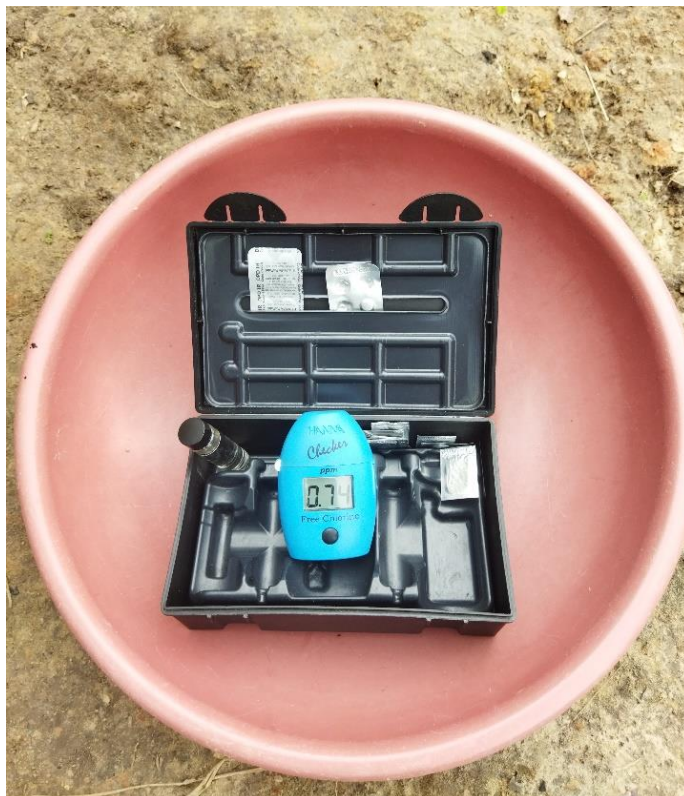
Fotografía 10. Resultado de muestra de cloro residual en PM-3
