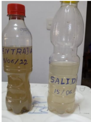
Foto N° 12: muestras del afluente y efluente, se observa mejor calidad del agua residual después del tratamiento construido
