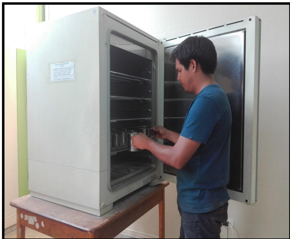
Foto 8: Se coloca las muestras para obtener el contenido de humedad.
