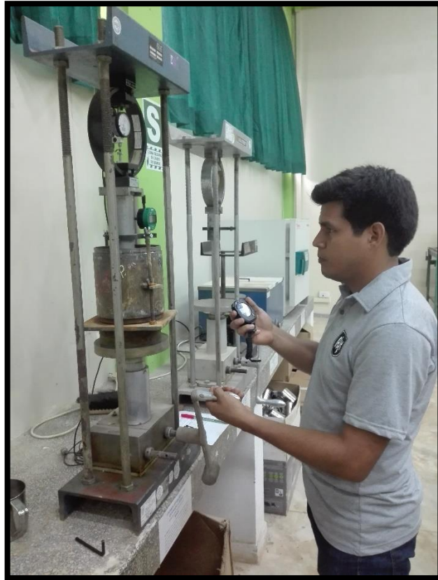
Foto 13: Aplicación de carga sobre el pistón de penetración mediante la prensa CBR.
