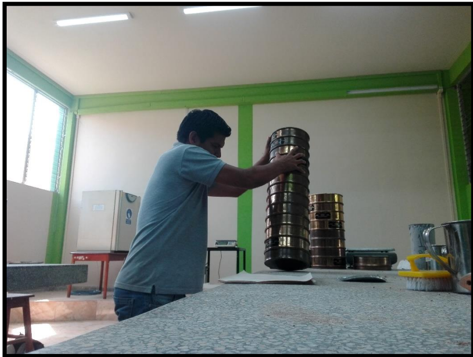
Foto 7: Análisis granulométrico de las muestras extraídas.
