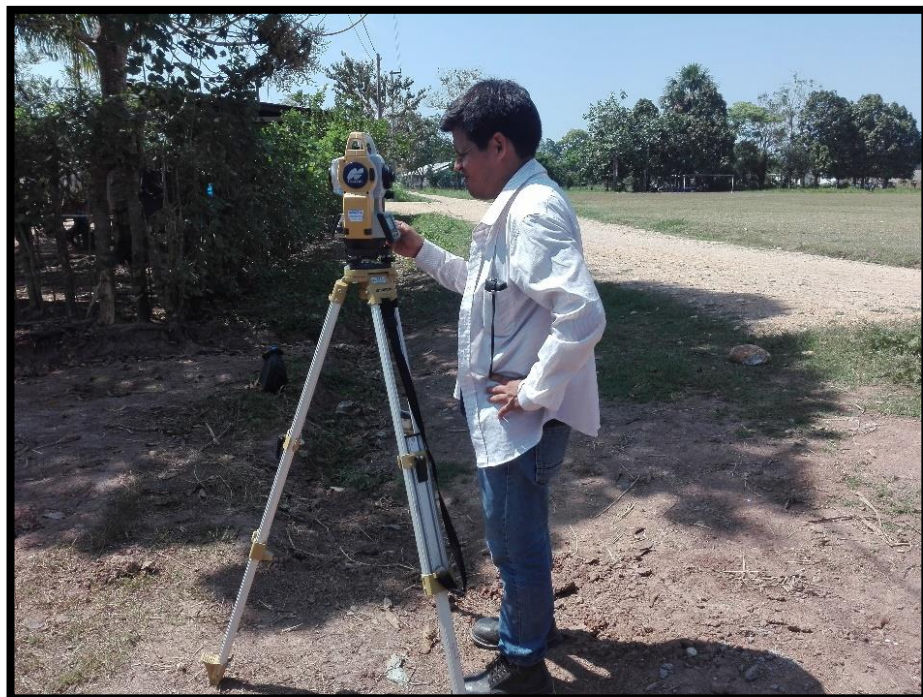
Foto 2: Levantamiento Topográfico con Estación Total.
