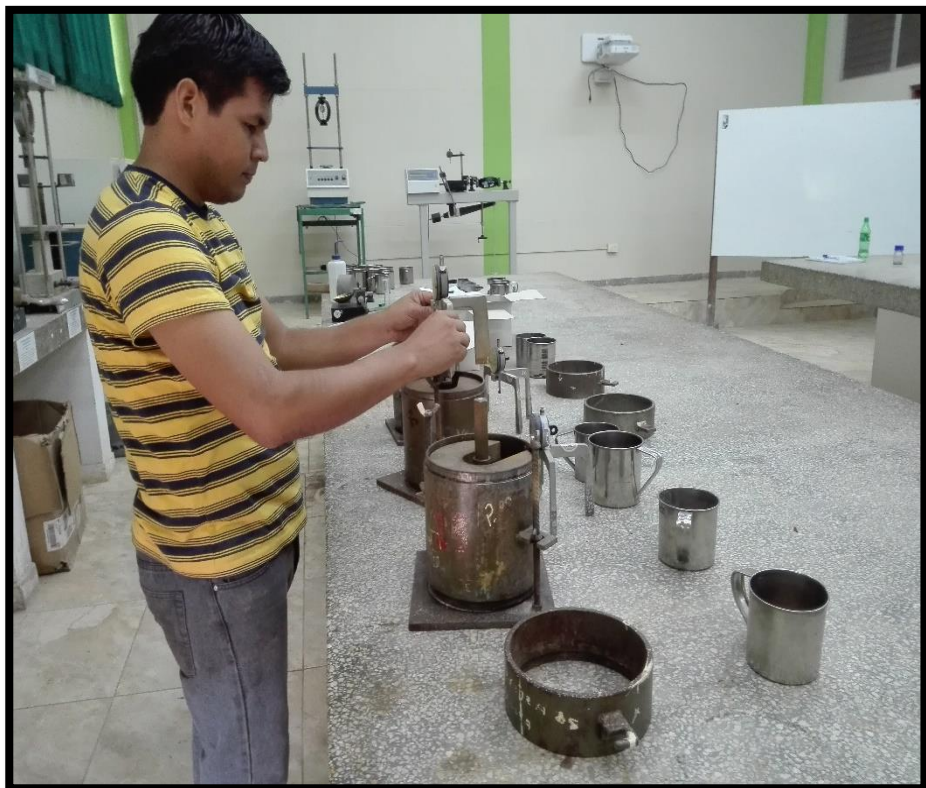
Foto 10: Colocación de placa perforadora y el vástago para calcular la sobrecarga.
