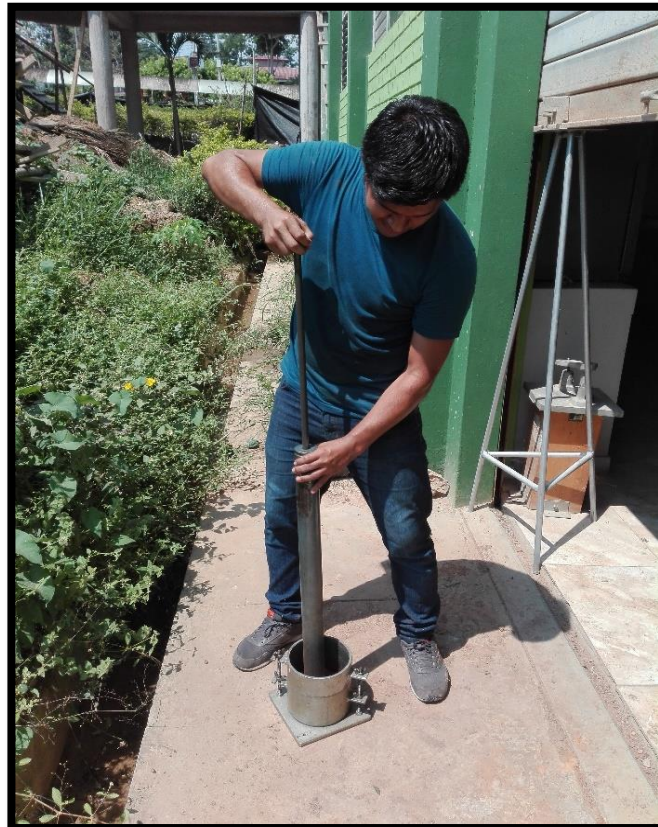
Foto 6: Realizando el ensayo de proctor modificado.
