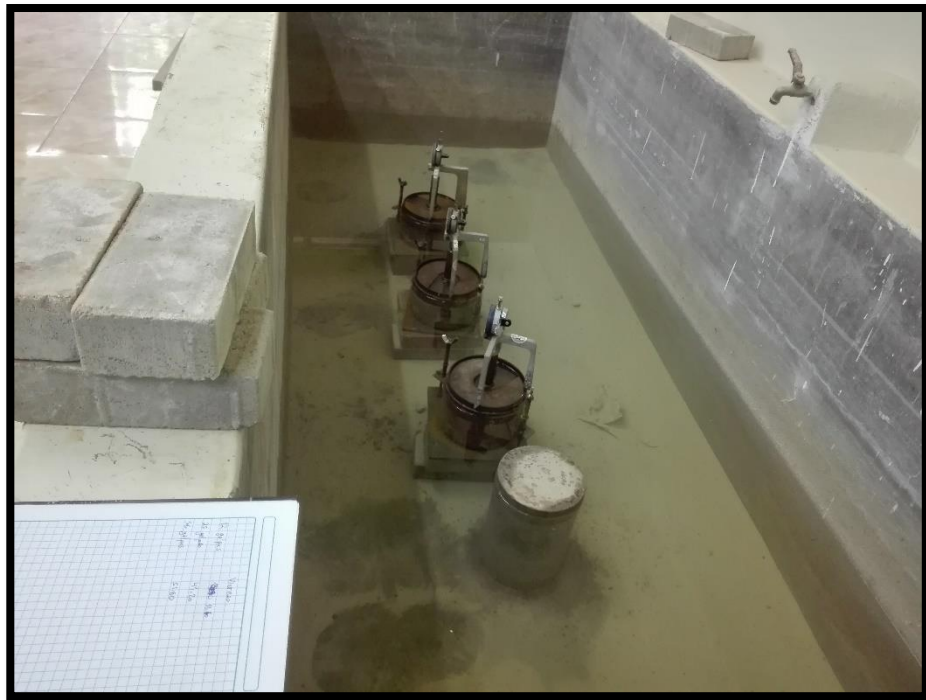
Foto 11: Moldes sumergidos con el trípode sobre el borde de cada molde.
