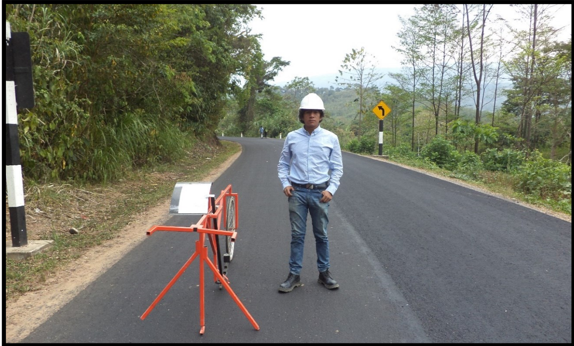
Figura 29: Equipo MERLIN calibrado y listo para la medición de la rugosidad a lo largo de la carretera.
