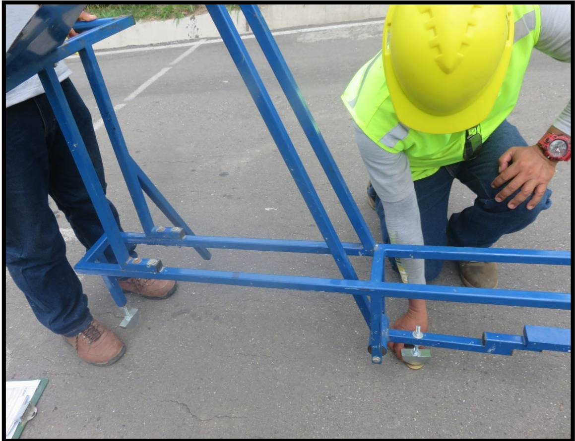
Figura 31: Se observa en la figura la calibración que se le está realizando al rugosímetro MERLIN para luego proceder a la medición del IRI.
