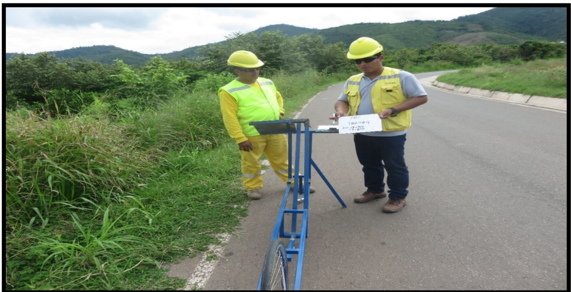
Figura 32: Se observa la medición del IRI usando el rugosímetro MERLIN.
