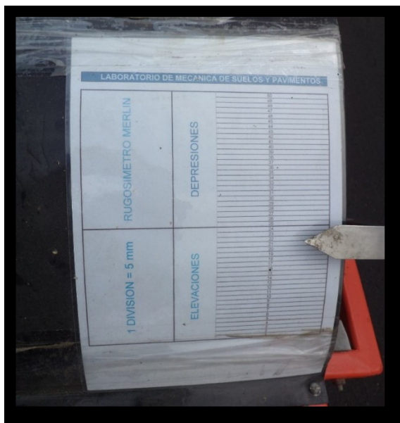
Figura 30: Valores de depresiones y elevaciones para el cálculo del IRI del equipo rugosímetro MERLIN
