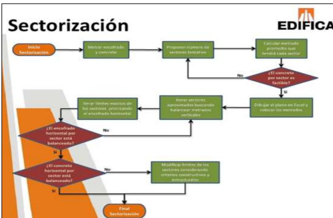
**Figura 18:** Proceso de Sectorización para edificaciones. (Fuente: Inmobiliaria EDIFICA).
