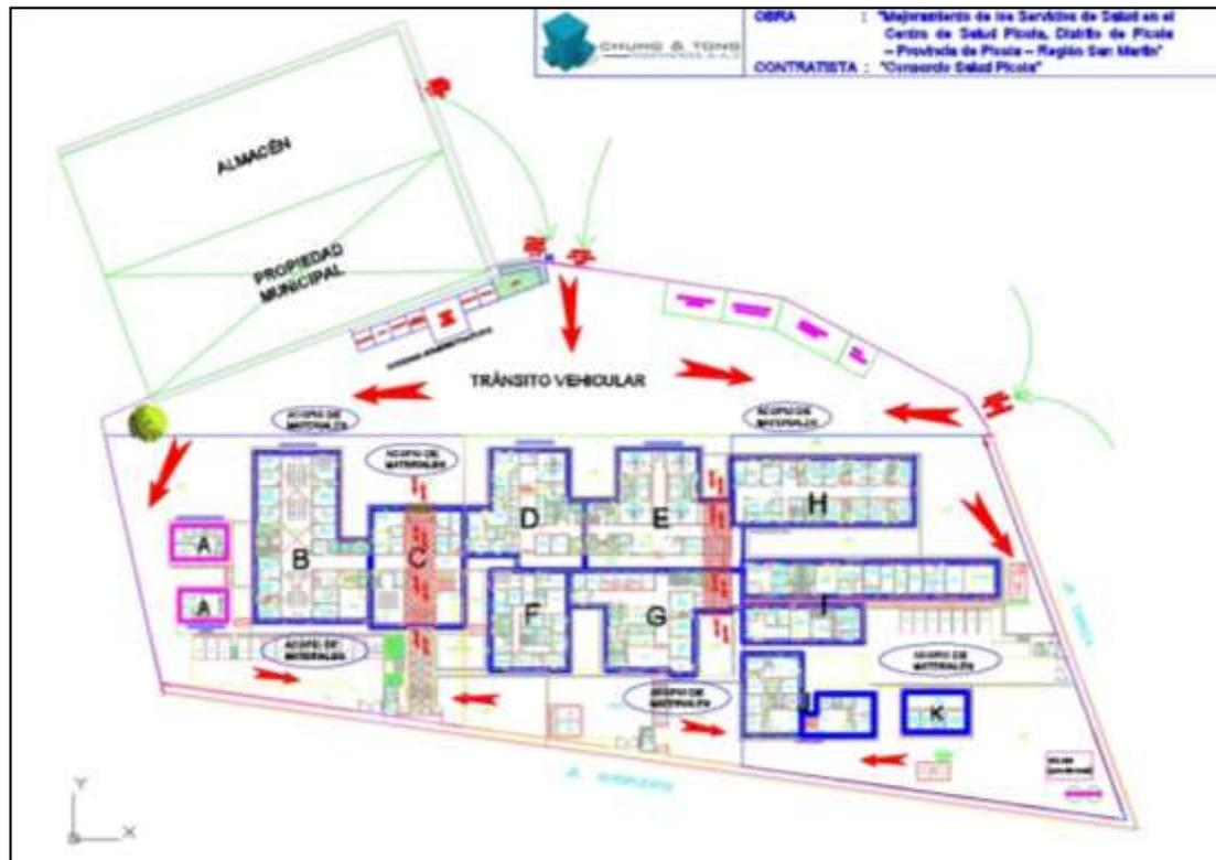
**Figura 33:** Gráfico del Layout de Obra. (Fuente: Elaboración propia – Ch&T 2015)
