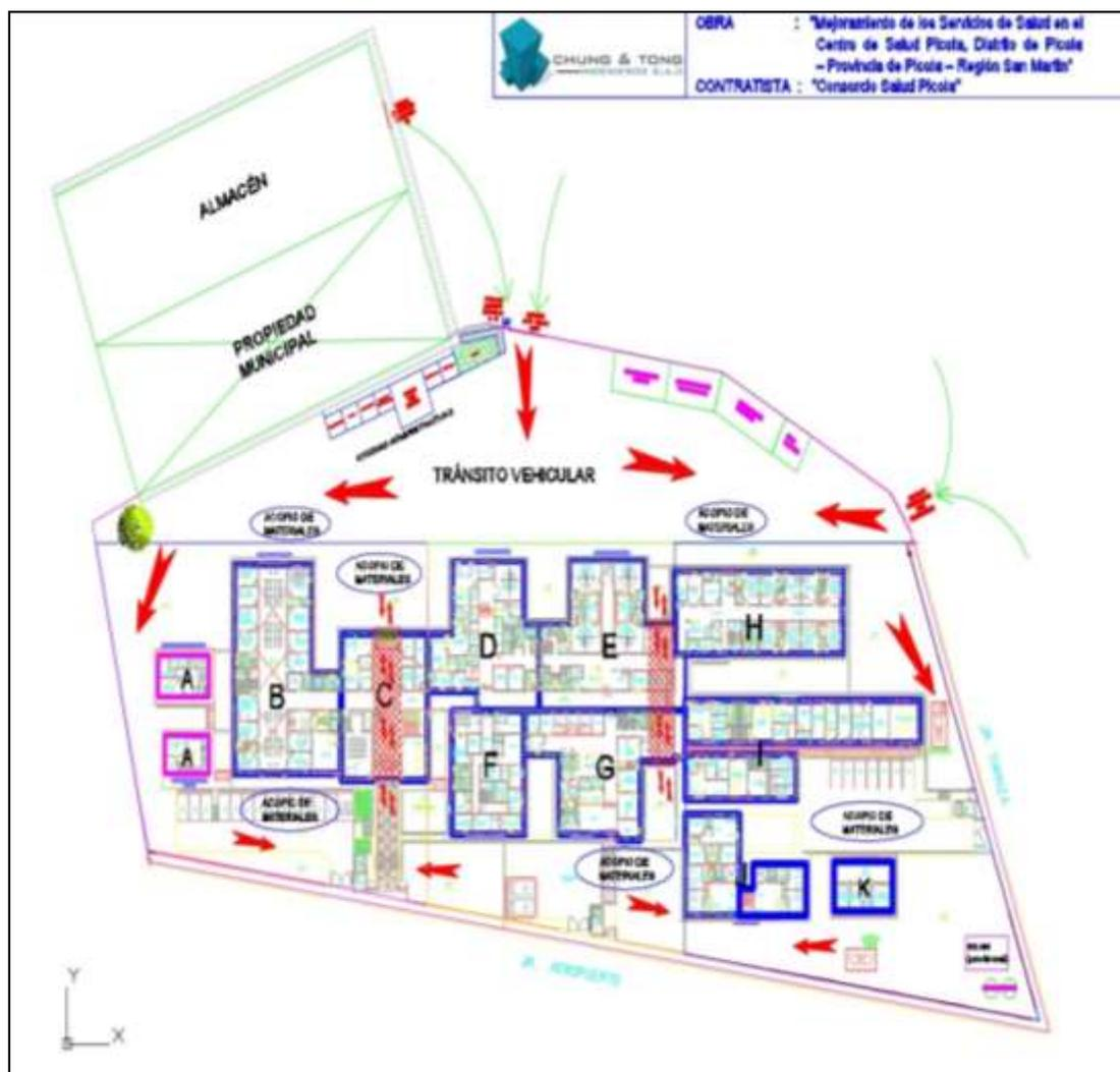
**Figura 22:** Esbozo del Layout de Obra. (Fuente: Elaboración propia – Ch&T 2015)
