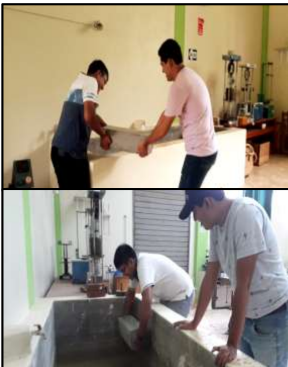
Foto 105: Colocamos los testigos en la cisterna.
