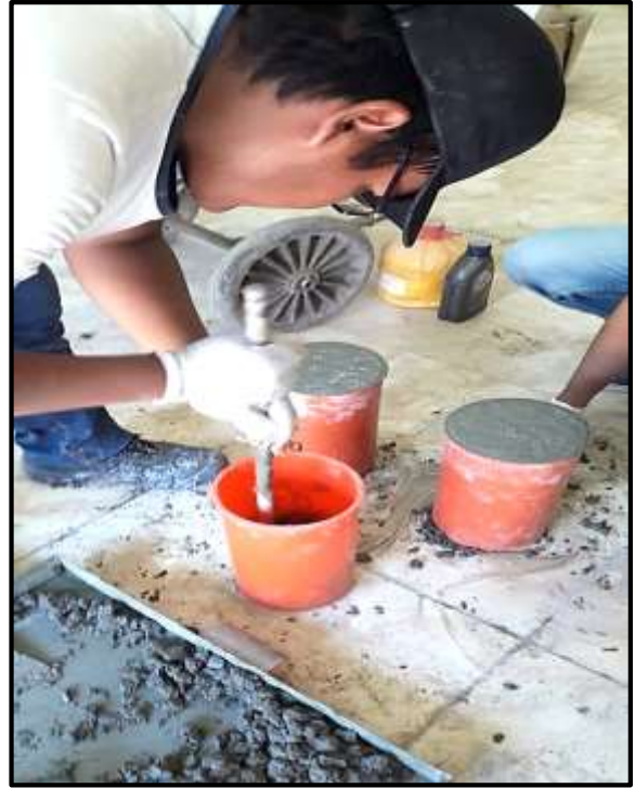
Foto 60: También utilizamos la varilla para el asentamiento hasta el llenado de la probeta.
