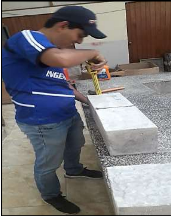
Foto 111: Tomamos las medidas a través de una de las caras fracturadas después del ensayo.
