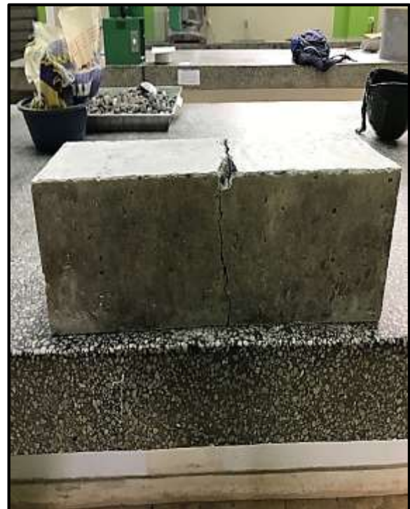
Foto 114: Vista de la rotura de la viga de concreto.
