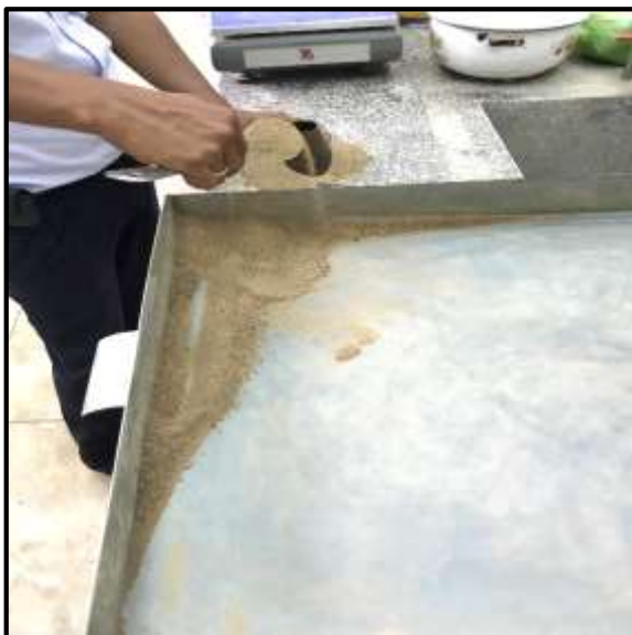
Foto 37: Aseguramos que la muestra este seca colocando cierta cantidad en el cono y dándole 25 golpes.
