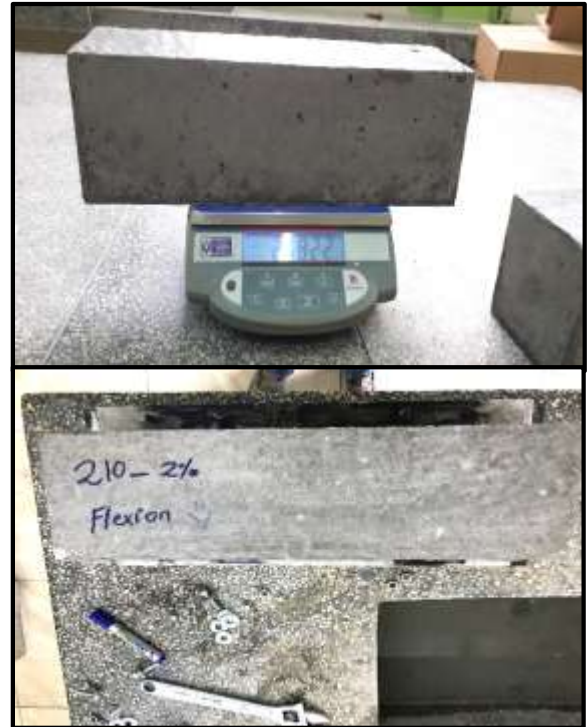
Foto 104: Registramos los pesos de los testigos enumerando por resistencia.
