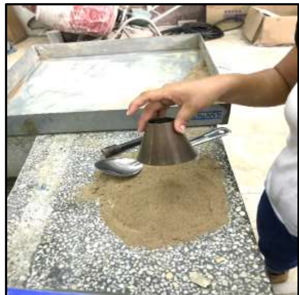
Foto 38: Comprobado esto, la muestra esta Saturada Seca Superficial.
