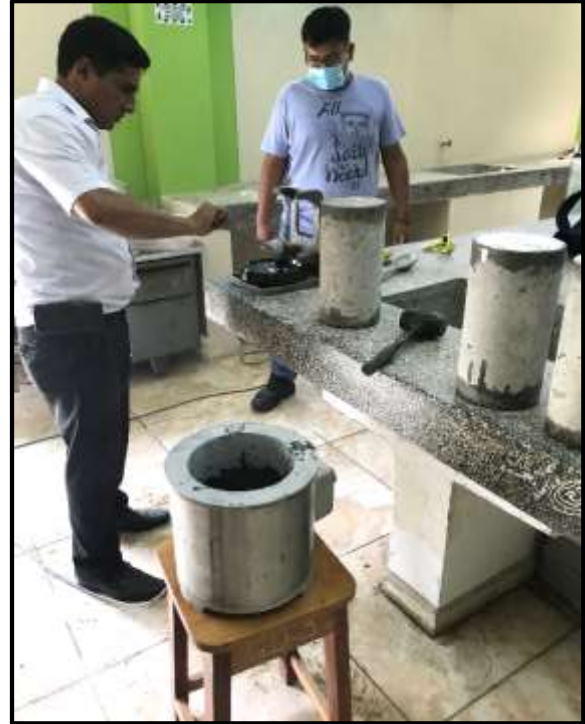
Foto 92: Para la rotura de las probetas se utilizó Caping.
