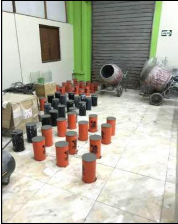
Foto 75: Las probetas están listas con diferentes dosificaciones de ceniza de cascarilla de arroz.
