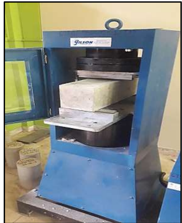
Foto 108: Colocamos el concreto en la Prensa Hidráulica apoyada en la maquina universal.
