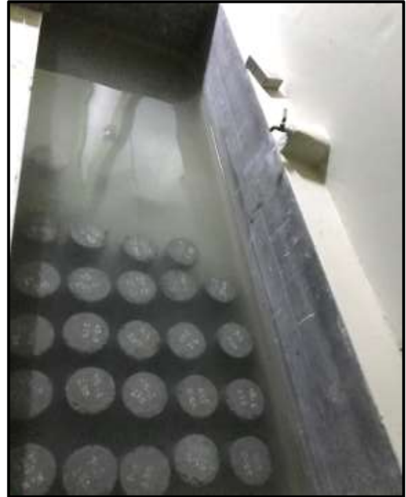
Foto 76: Después de desencofrar registramos los pesos y colocamos en la cisterna para el curado.
