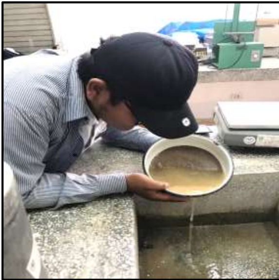
Foto 35: Seleccionamos la muestra de agregado fino saturada.
