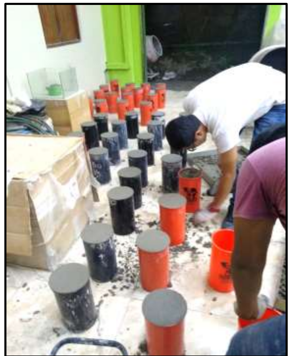
Foto 74: También utilizamos la varilla para el asentamiento hasta el llenado de la probeta.
