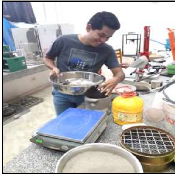
Foto 19: Al agregado grueso colocamos en el Recipiente Metálico para obtener su Peso Unitario Suelto.
