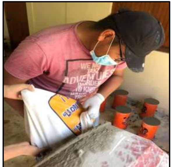
Foto 70: Ingresamos los agregados al trompo para obtener la mezcla repitiendo los pasos anteriormente descritos.
