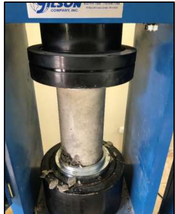
Foto 78: Registramos las resistencias de cada una de la rotura de testigos.
