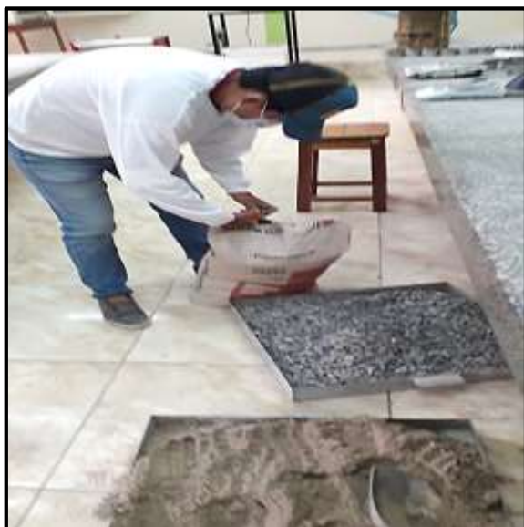
Foto 79: Seleccionamos los agregados y el cemento para obtener la cantidad según diseño.
