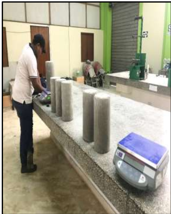
Foto 66: Registramos las resistencias de cada una de la rotura de testigos.
