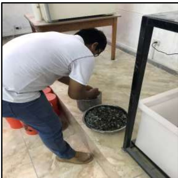
Foto 13: Al agregado grueso seco lo colocamos en una canasta y lo pesamos (Peso de canasta + Peso muestra seca) y llenamos el recipiente con agua.
