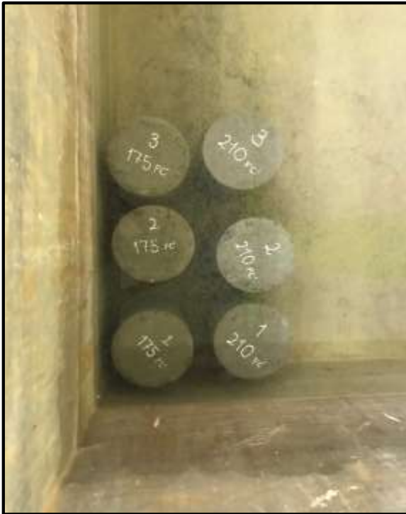
Foto 63: Se coloca en la cisterna con agua para el curado durante 7, 14 y 28 días.
