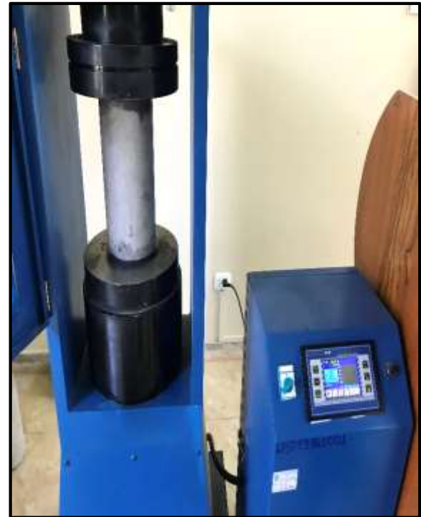
Foto 94: Registramos las resistencias de cada una de la rotura de testigos.
