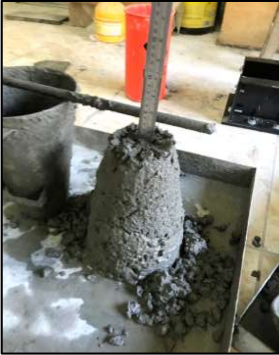
Foto 99: Se llena por completo el cono de Abrams y medimos el asentamiento en pulgadas.
