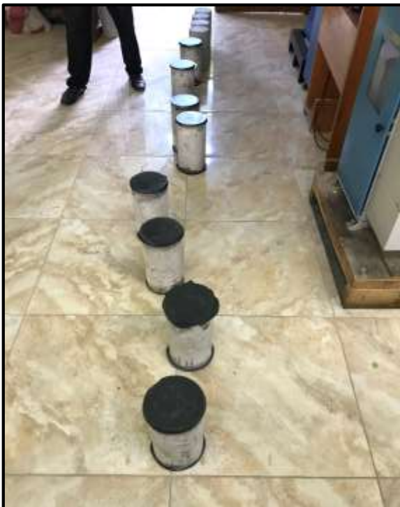
Foto 93: Colocamos Caping a cada uno de las probetas y colocamos en la Prensa Hidráulica.
