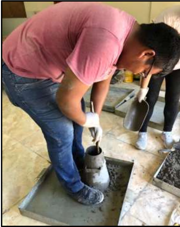
Foto 71: Sujetamos con los pies el molde del cono de Abrams y procedemos a vaciar la mezcla.
