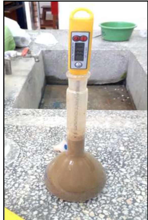
Foto 42: Una vez colocado los 500 gr de muestra obtenemos la temperatura.
