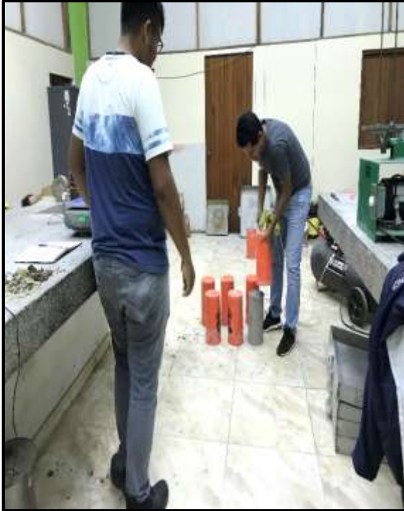
Foto 87: Desencoframos los moldes con la ayuda de la compresora.
