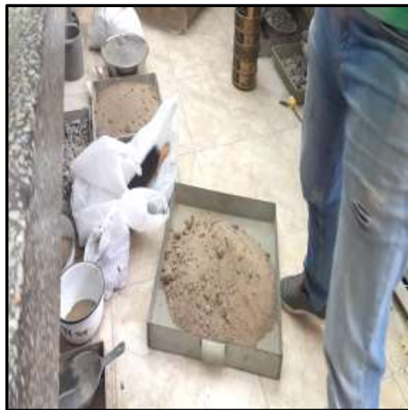
Foto 48: Las muestras colocamos en recipientes para ponerlos en la mezcladora.
