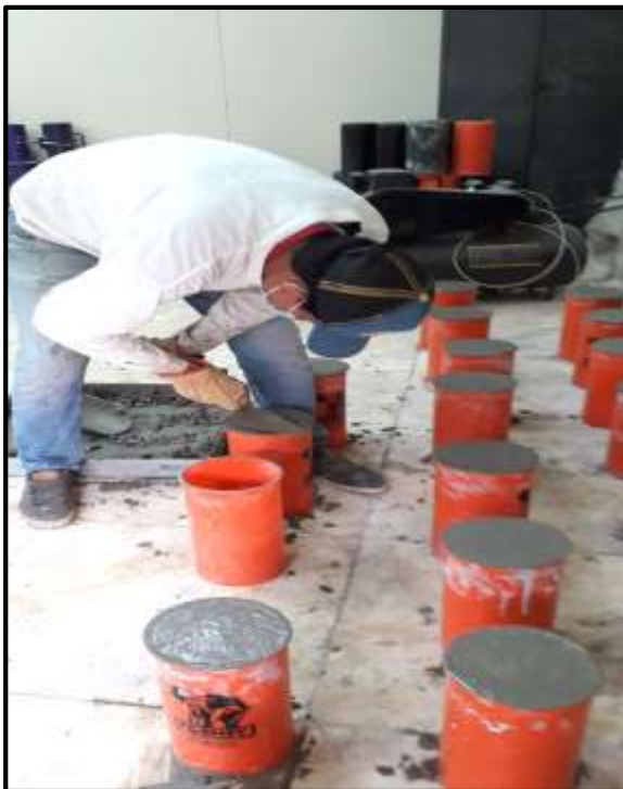
Foto 85: Procedemos al llenado de las probetas en tres capas realizando golpes con martillo de goma.
