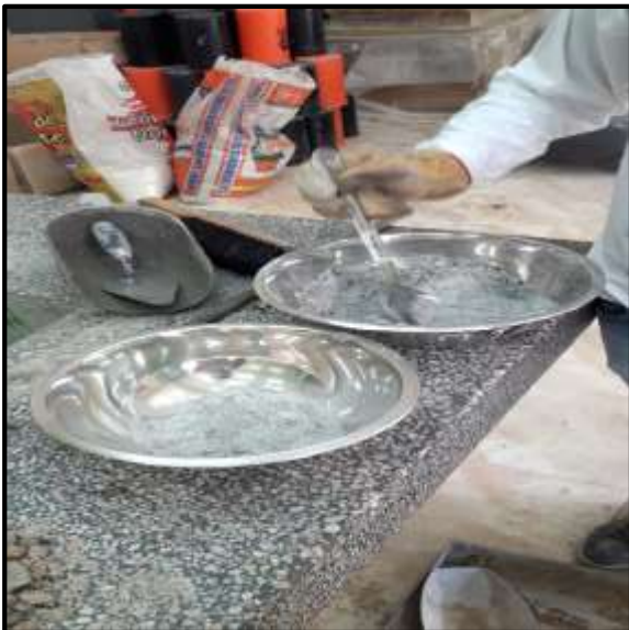
Foto 69: La dosificación de la ceniza es agregada en porcentajes al cemento.
