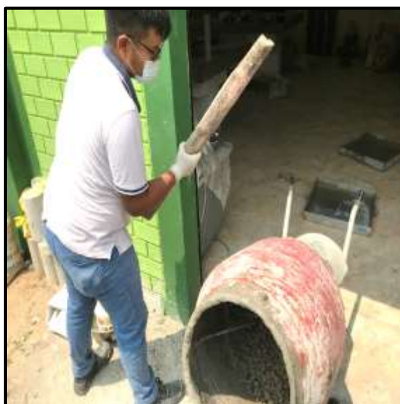
Foto 82: Vaciamos la mezcla para elaborar las probetas y cono de Abrams.
