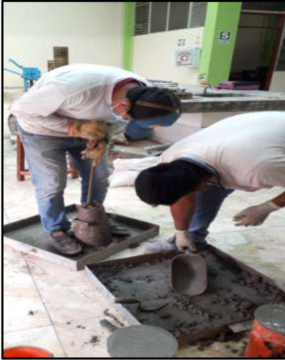
Foto 83: Se llena por completo el cono de Abrams y procedemos a sacar suavemente el molde.
