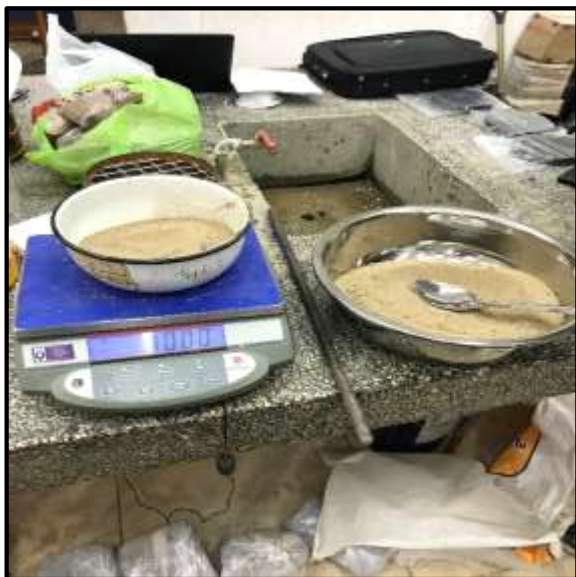
Foto 25: Taramos el envase y pesamos 1000 gr. de del agregado fino.
