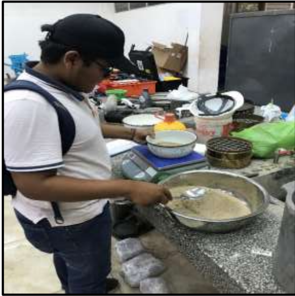
Foto 23: Realizamos el Ensayo del Peso Específico del agregado fino.
