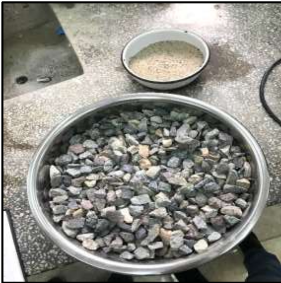
Foto 27: La muestra seleccionada el agregado fino y agregado grueso para el Ensayo de Granulometría.
