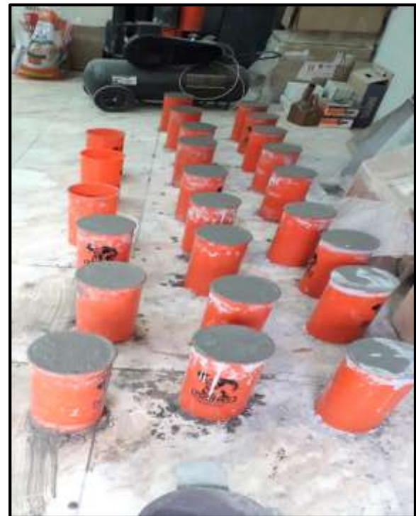
Foto 86: Las probetas están listas con diferentes dosificaciones de ceniza de cascarilla de arroz.
