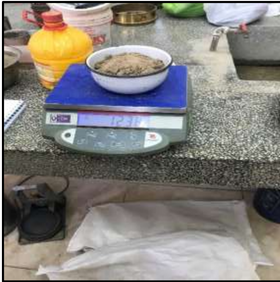
Foto 7: Separamos 1000 gr. del agregado fino.
