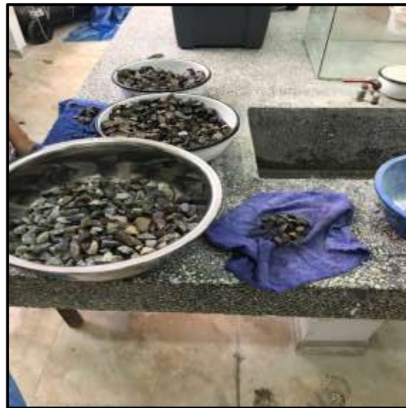
Foto 12: El agregado grueso saturado lo secamos piedra por piedra.
