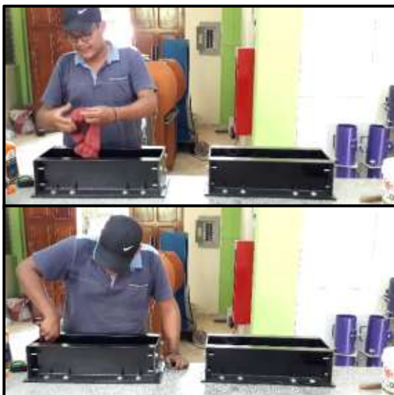
Foto 95: Empezamos preparando los moldes metálicos de la viga.
