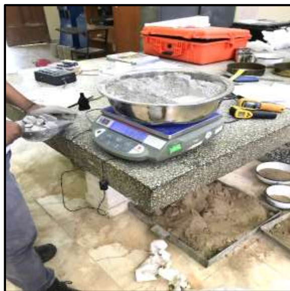
Foto 49: Seleccionamos el cemento según la cantidad del diseño de mezcla.
