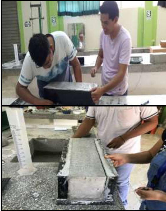
Foto 103: Al día siguiente desencoframos los moldes de la viga.
