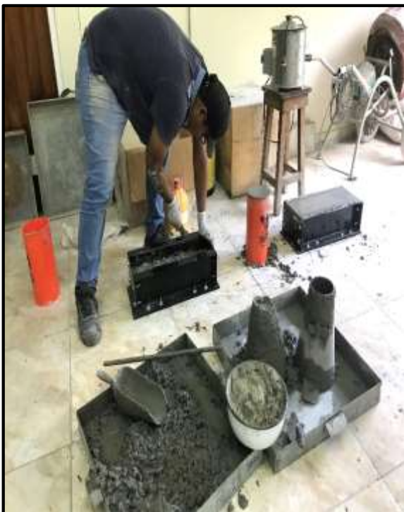
Foto 101: Procedemos al llenado de las vigas en tres capas realizando golpes con martillo de acero.
