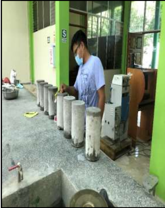
Foto 91: Retiramos las probetas, lo dejamos secar y limpiamos los extremos con aceite.
