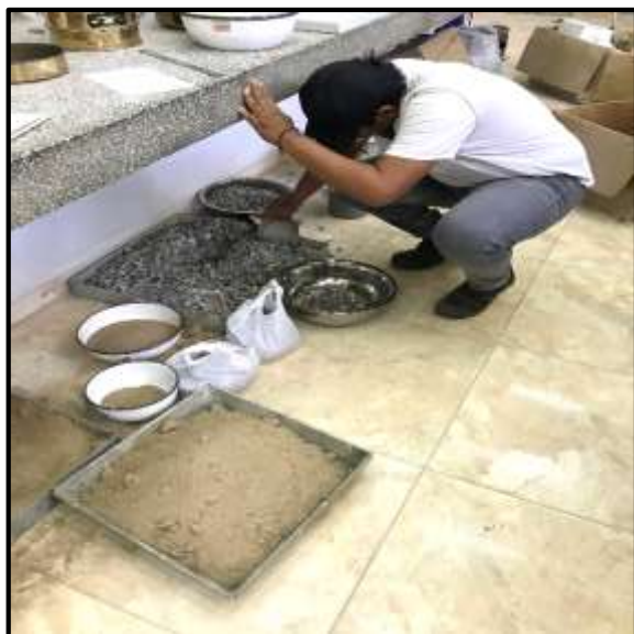
Foto 47: Seleccionamos los agregados y el cemento para obtener la cantidad según diseño.
