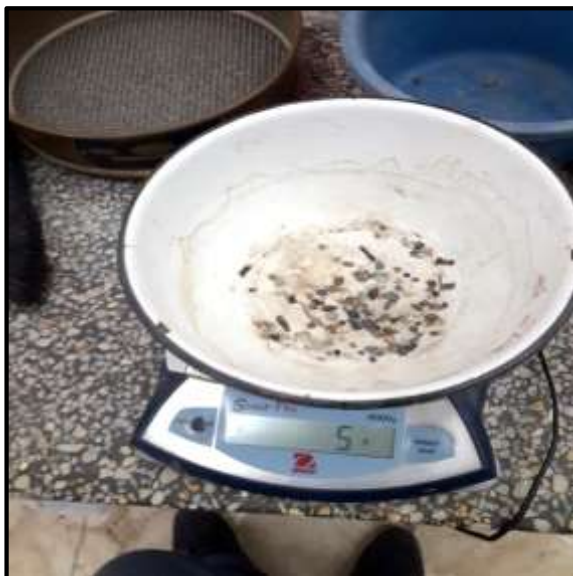
Foto 33: Se registra el peso del material retenido en cada tamiz.
