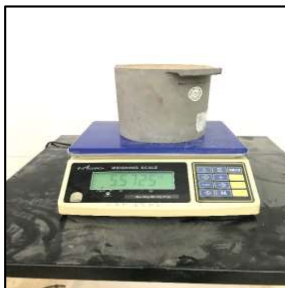
Foto 18: Finalmente obtenemos del agregado fino Su Peso Unitario Compactado.
