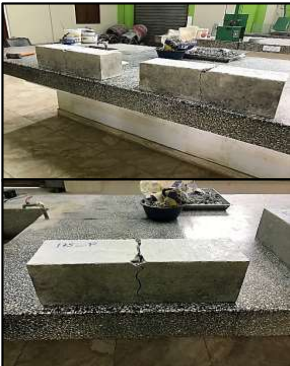
Foto 113: Vista de la rotura de la viga de concreto.
