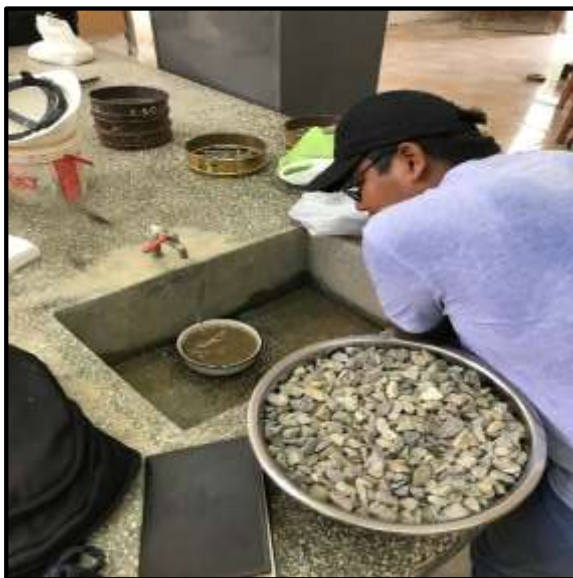
Foto 9: Saturamos el agregado fino y grueso.
