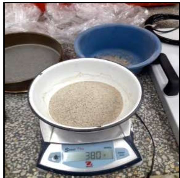
Foto 34: Se registra el peso del material retenido en cada tamiz.
