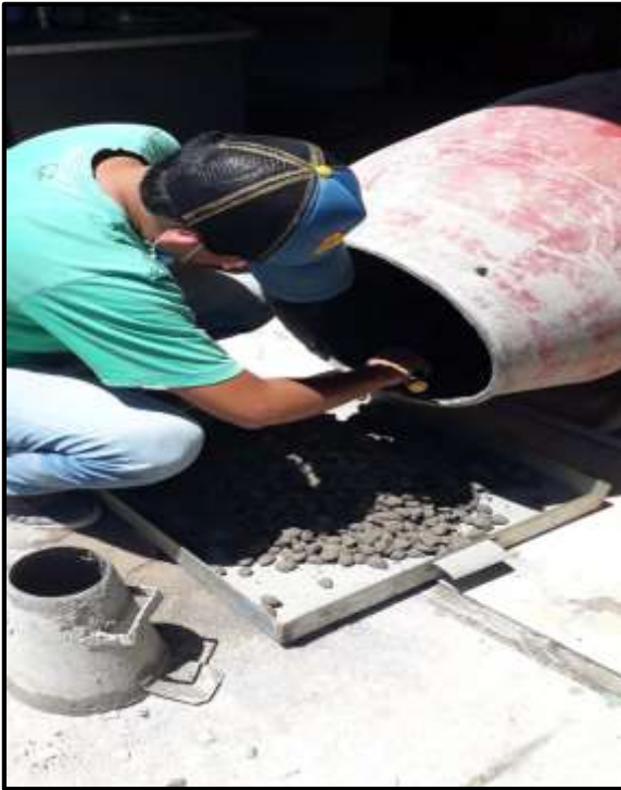
Foto 55: Vaciamos la mezcla para elaborar las probetas y cono de Abrams.
