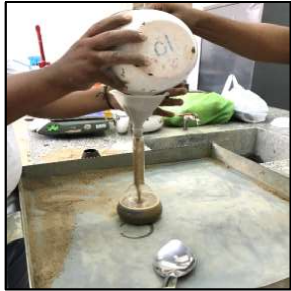
Foto 40: Agregamos la muestra de arena (500 gr.) en el picnómetro dividida en tres partes.
