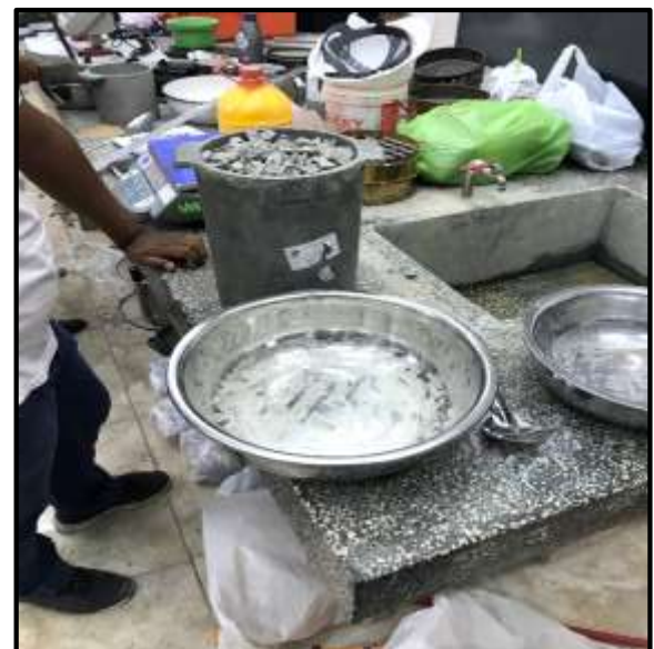
Foto 22: Finalmente obtenemos del agregado Su Peso Unitario Compactado.
