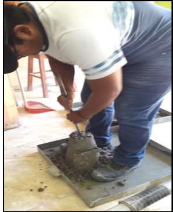
Foto 56: Sujetamos con los pies el molde y procedemos a vaciar la mezcla al cono en tres capas, dándole 25 golpes con la varilla.
