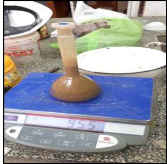
Foto 44: Registramos el peso del Picnómetro con la arena.
