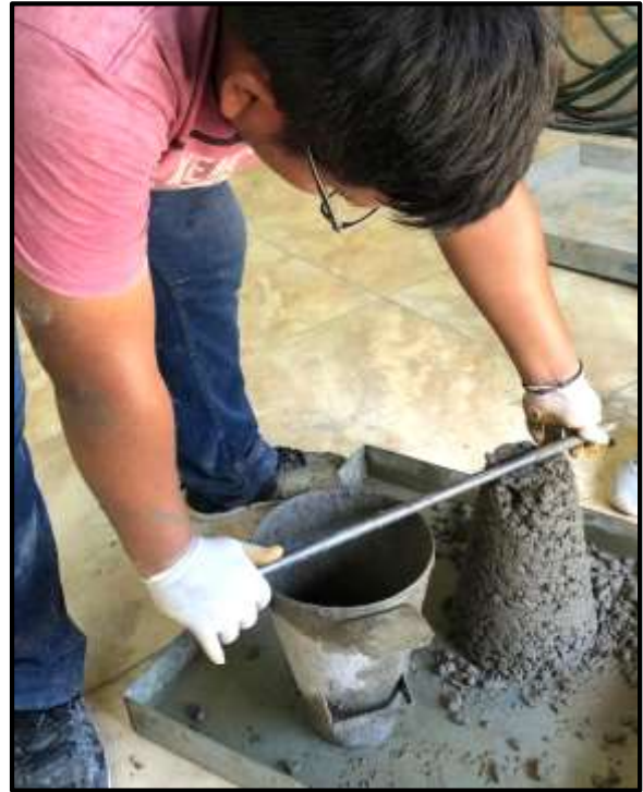
Foto 72: Se llena por completo el cono de Abrams y medimos el asentamiento.
