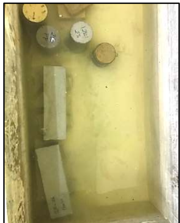
Foto 106: Se coloca en la cisterna con agua para el curado durante 7, 14 y 28 días.
