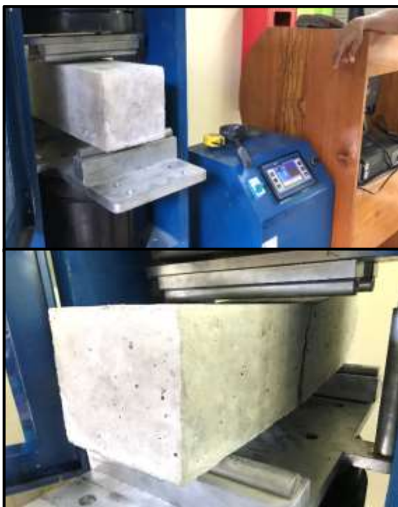
Foto 109: Alineamos la viga en los puntos de apoyo y aplicamos la carga para obtener la resistencia.
