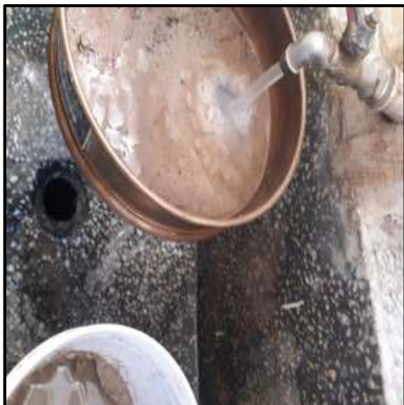
Foto 11: El agregado fino saturado lo pasamos por la Malla #200 lavando la muestra para posteriormente colocar en el horno por 24 horas.
