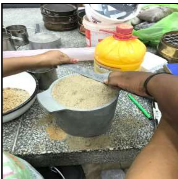
Foto 17: Después de compactar las capas enrasamos a nivel del recipiente.
