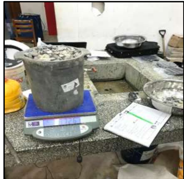
Foto 20: Para obtener el Peso Unitario Compactado de la Grava lo colocamos por partes compactando.
