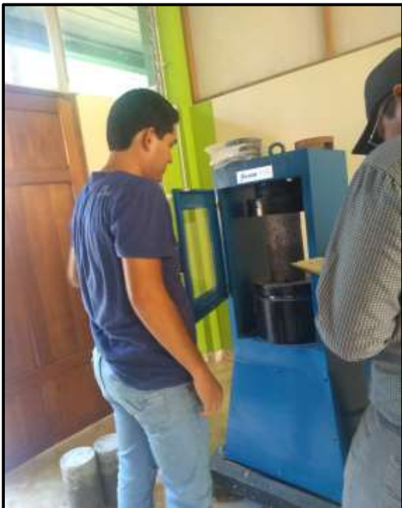
Foto 77: Colocamos el concreto en la Prensa Hidráulica y obtenemos la resistencia cuando se agrieta el concreto.
