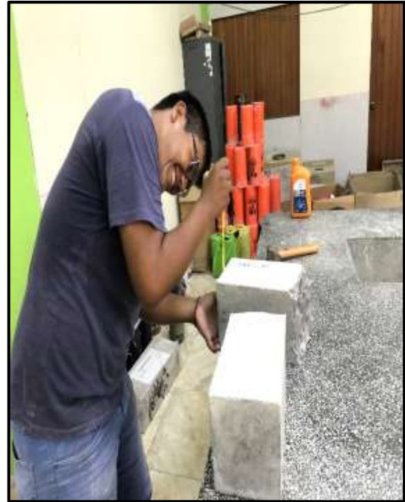
Foto 112: Tomamos las medidas a través de una de las caras fracturadas después del ensayo.
