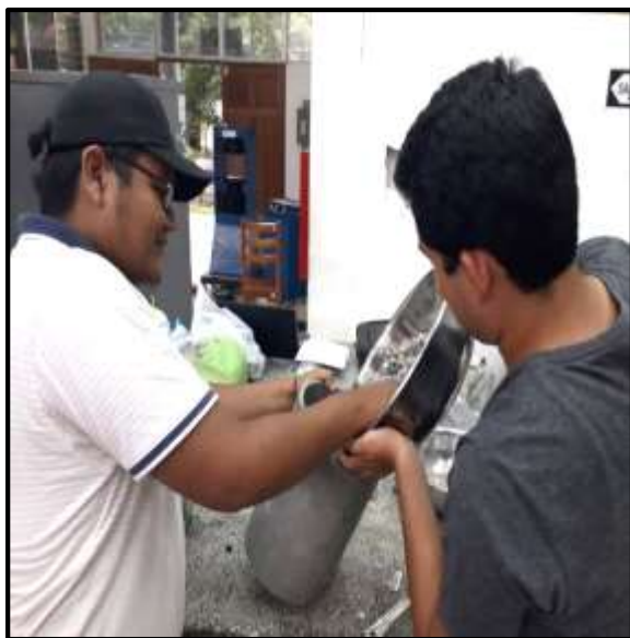
Foto 21: Después de compactar las capas enrasamos grueso a nivel del recipiente.
