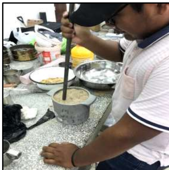
Foto 16: Para obtener el Peso Unitario Compactado de la Arena lo colocamos por partes compactando.
