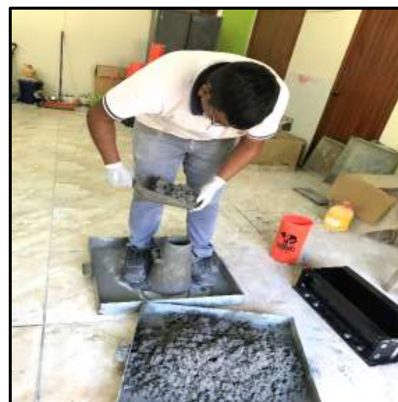
Foto 98: Sujetamos con los pies el molde de cono de Abrams y procedemos a vaciar la mezcla.
