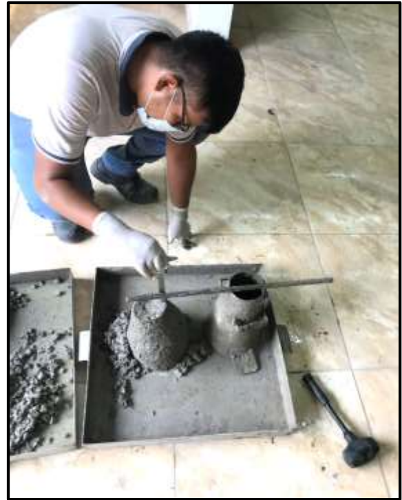
Foto 84: Una vez sacado el molde se mide el asentamiento en pulgadas.
