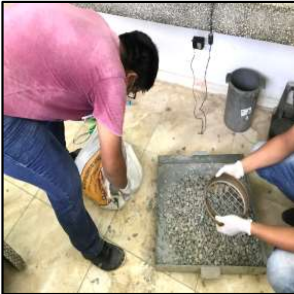
Foto 67: Seleccionamos los agregados y el cemento para obtener la cantidad según diseño.
