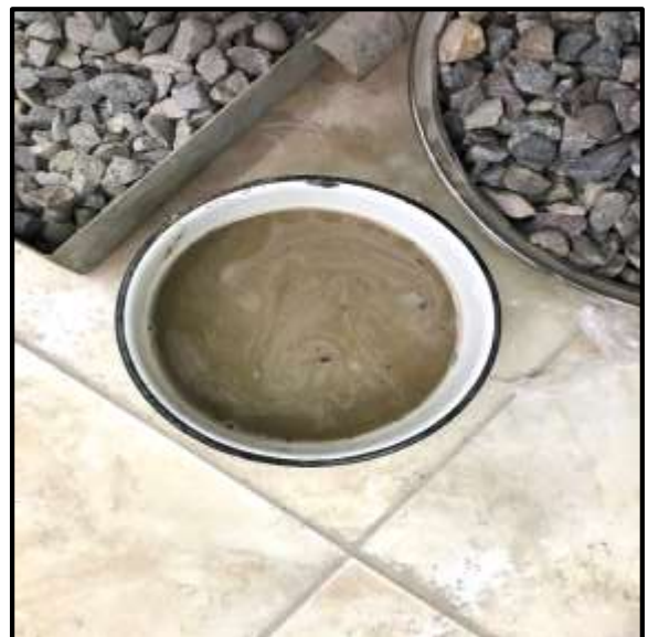
Foto 26: Saturamos la muestra por 24 horas.
