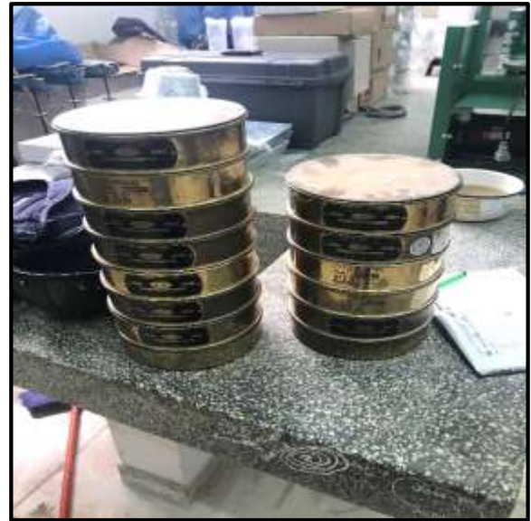
Foto 28: Colocamos la serie de tamices N° 3/8, 4, 8, 16, 30, 50, 100 para el agregado fino y tamices N° 1, 3/4, 1/2, 3/8, 4 para agregado grueso.
