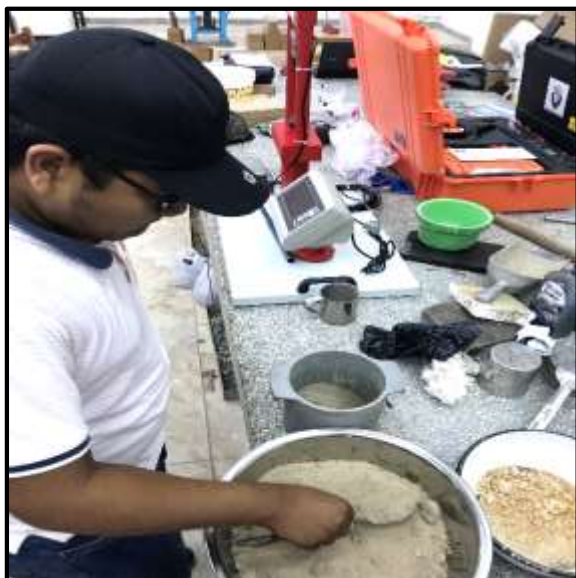
Foto 15: Al agregado fino colocamos en el Recipiente Metálico para obtener su Peso Unitario Suelto.
