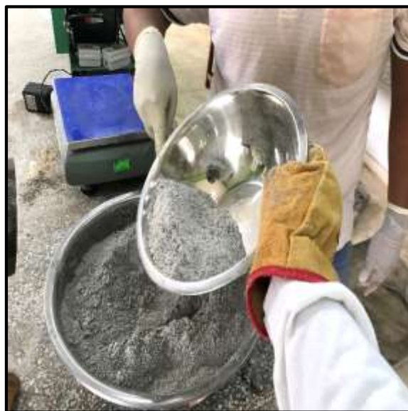
Foto 80: La dosificación de la ceniza es agregada en porcentajes al cemento.
