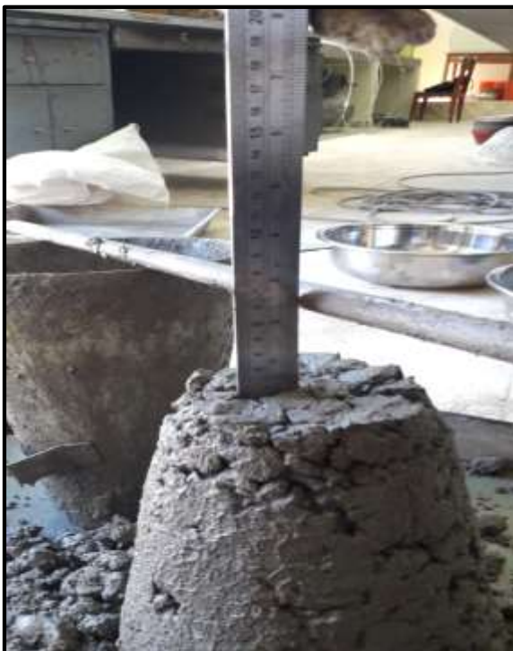
Foto 57: Se llena por completo el cono de Abrams y procedemos a sacar suavemente el molde.
