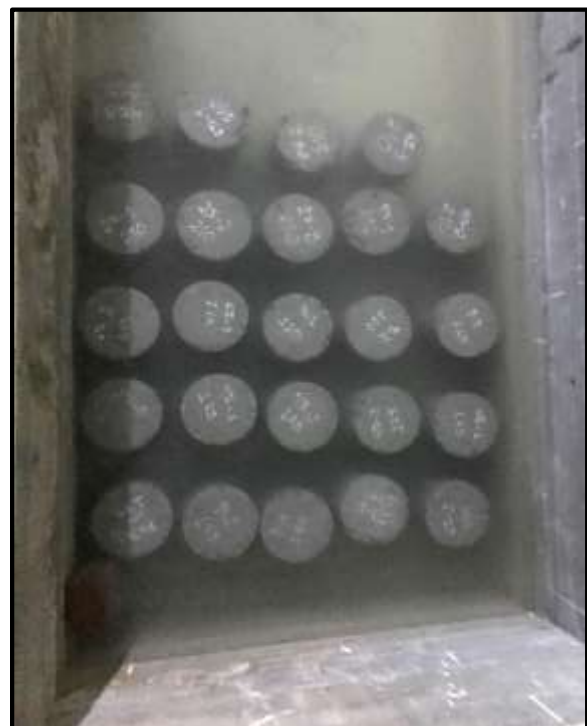
Foto 90: Se coloca en la cisterna con agua para el curado durante 7, 14 y 28 días.
