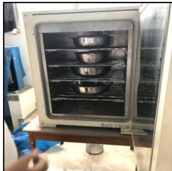
Foto 6: Selección de los agregados y colocación en el horno por 24 horas.
