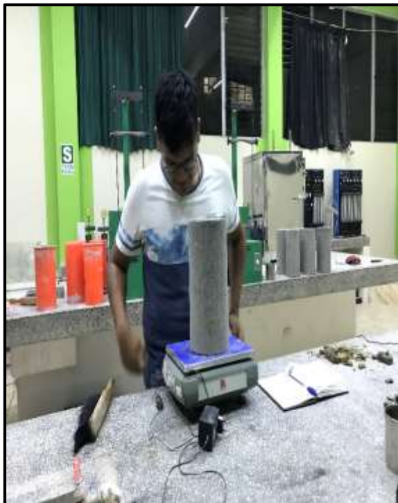
Foto 89: Registramos los pesos de las probetas.
