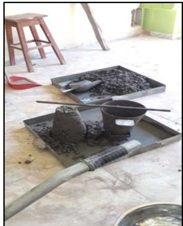
Foto 56: Sujetamos con los pies el molde y procedemos a vaciar la mezcla al cono en tres capas, dándole 25 golpes con la varilla.
