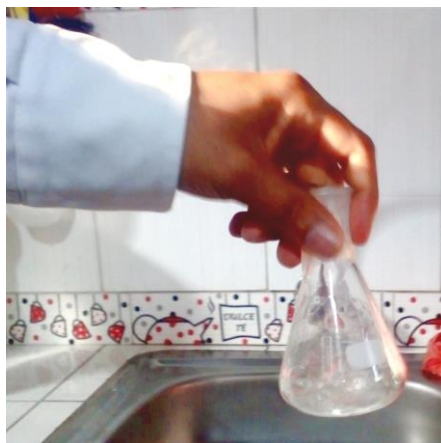
Figura 6B. Agitación manual de la mezcla de metanol e hidróxido de sodio.
