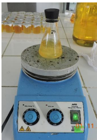
Figura 3B. Calentamiento/agitación del aceite.
