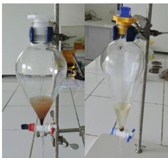
Figura 16B. Decantación de arcillas.
