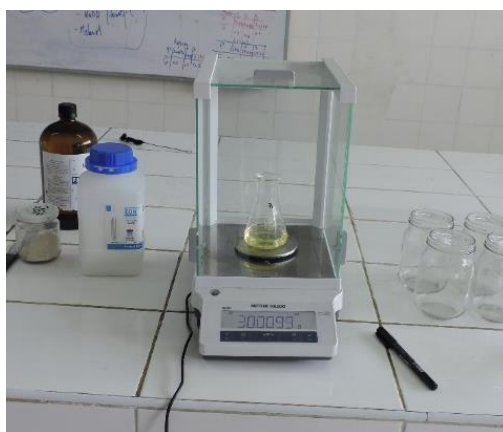
Figura 18B. Pesado del biodiésel purificado.
