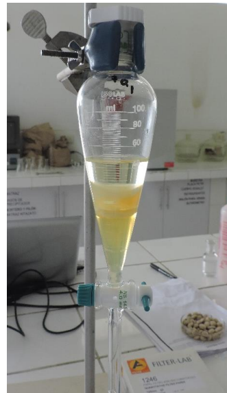
Figura 13B. Decantación con agua.
