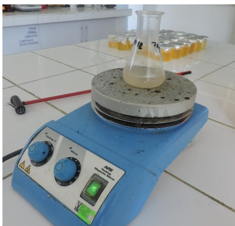
Figura 15B. Calentamiento/agitación con arcilla.
